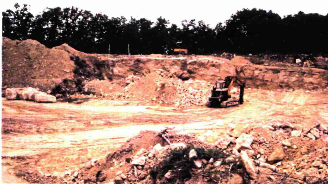
Pl. 1 - Carrière de Bernat : banc supérieur dur fissuré (1) et niveau inférieur (2).
