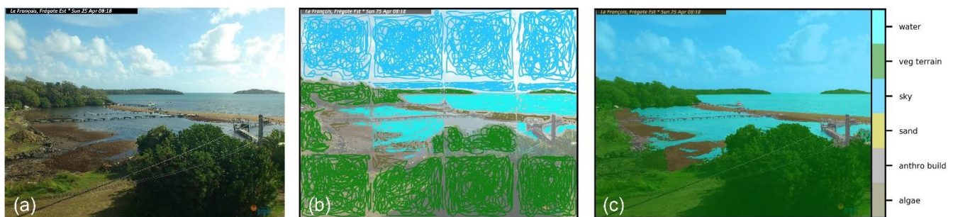
Figure 14 : (a) image brute capturée à Frégate Est au François à l'aide du dispositif SolarCam, (b) étiquetage manuel (couleurs) superposé sur l'image brute selon les différentes classes d'intérêt et (c) classification automatique de l'image par l'algorithme.
