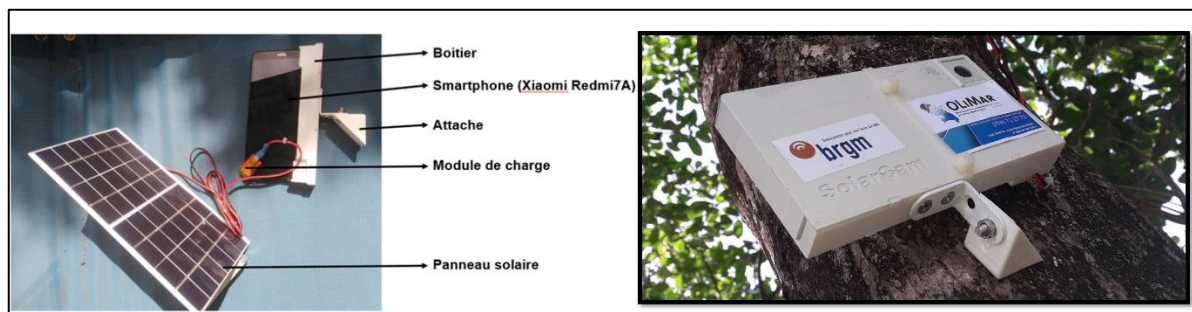
Figure 2 : Description et composants du dispositif de suivi © SolarCam à gauche et exemple d'une installation sur le site de Anse Charpentier à droite.
