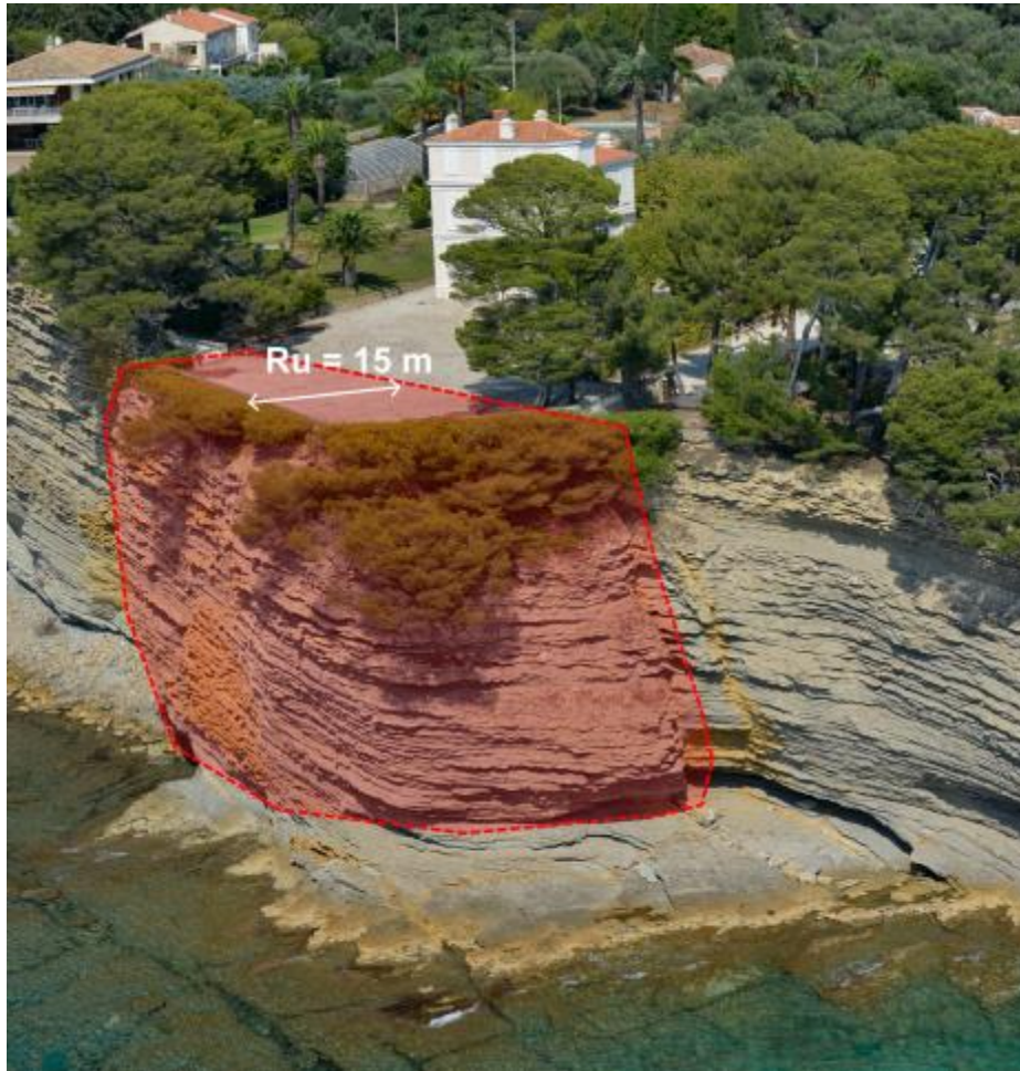
Figure 89 : Configuration ponctuelle très défavorable avec compartiment massif sous-cavé, fracturé par l'arrière (La Ciotat – Photo : DDTM13, 2020)
