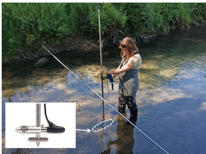
Figure 6 - Mesure au courantmètre électromagnétique
