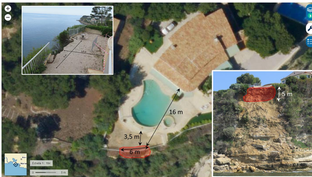
Illustration 10 : Évaluation du volume éboulé retranscrit sur photo aérienne ( http://m.geoportail.fr/ ) et sur les photos prises depuis le jardin et depuis le bateau en aval
