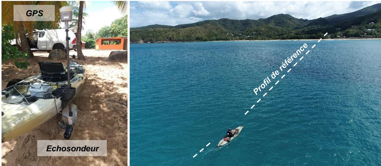
Illustration 6 - Dispositif de suivi bathymétrique. Équipement pour les mesures bathymétriques (à gauche) et levé le long d'un profil de référence sur le site de la plage de la Perle (à droite)
