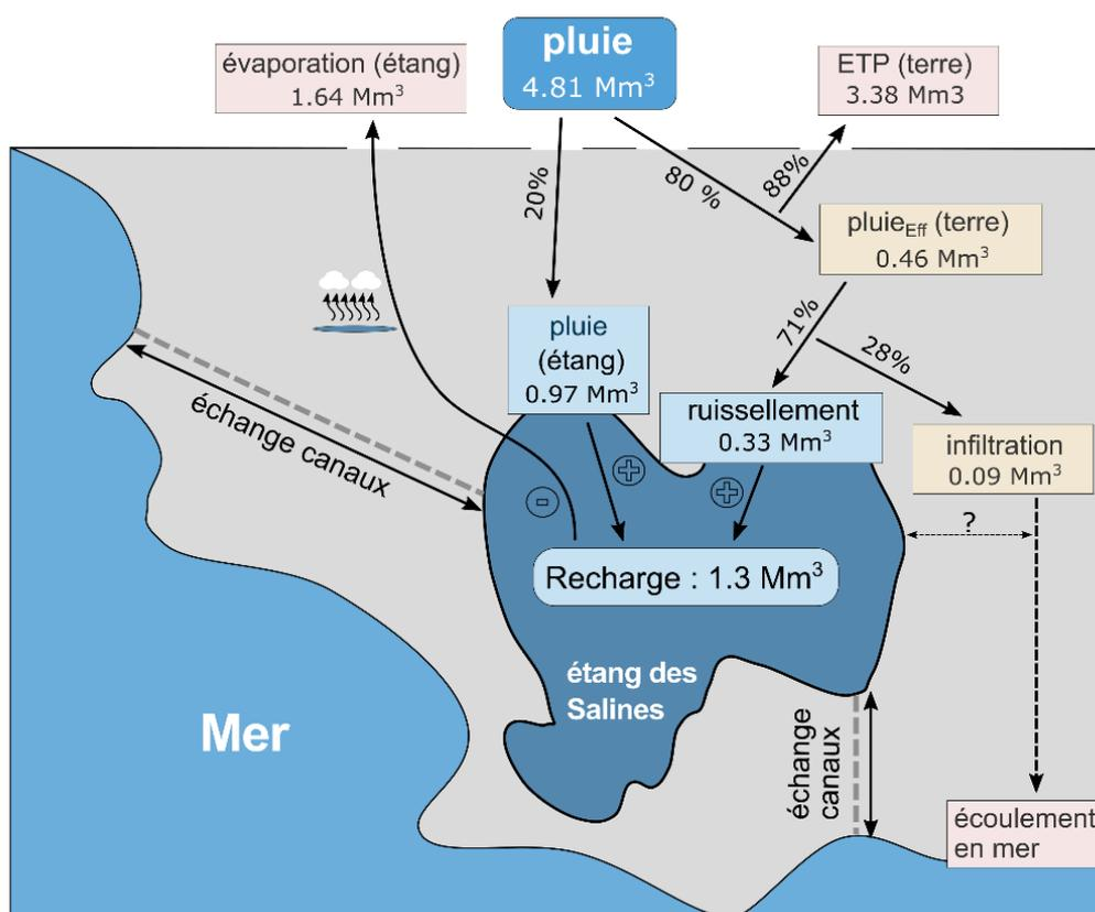
Figure 12 : schéma conceptuel illustrant le bilan hydrologique ( $\text{Mm}^3/\text{an}$ ) à l'échelle du bassin versant de la lagune des Salines. La présence de l'étang définit comme surface en eau est prise en compte pour la caractérisation de l'évapotranspiration.
