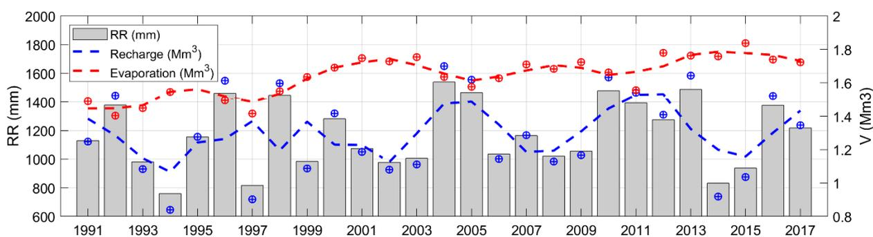
Figure 14 : précipitation (RR en mm) et recharge théorique annuelle en eau douce (V, en Mm<sup>3</sup>) sur l'étang des Salines. Bilan hydrologique réalisé entre 1991 et 2017 (27 ans).
