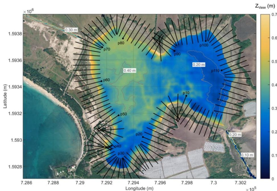
Figure 28: Epaisseur de sédiments meubles dans l'étang des salines. Carte topo-bathymétrique de l'épaisseur de vase  $Z_{vase}$  (m). Chacun des profils analysés est illustré sur le panel supérieur par des traits noirs le long des berges. Fond de carte : BD ORTHO® 2017.
