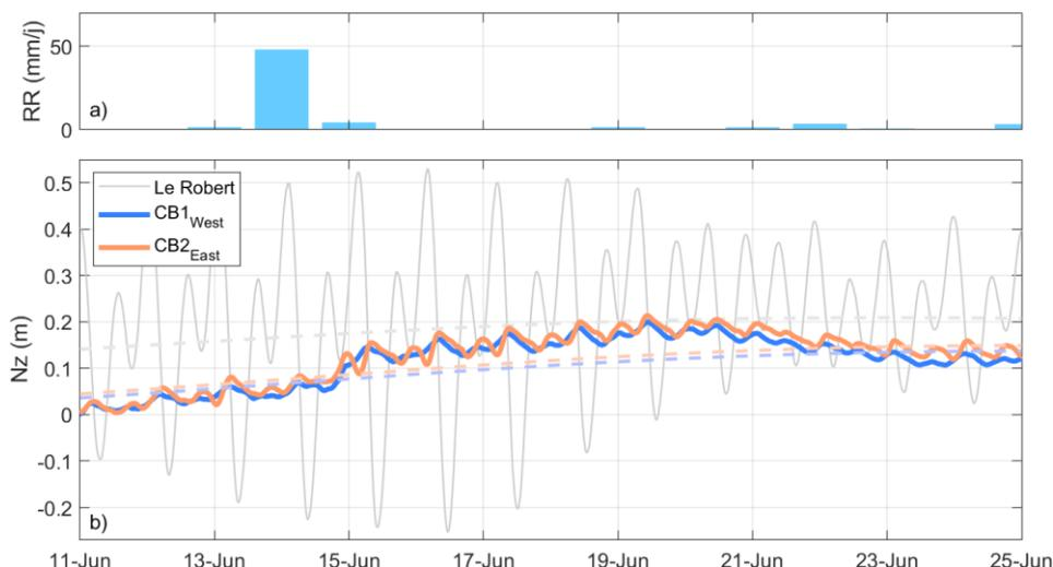
Figure 16 : Evolution temporelle des niveaux d'eau dans la lagune. a) Pluviométrie journalière (RR en mm/j). b) Niveaux d'eau mesurés au Robert (en gris) et dans la lagune aux stations CB1<sub>West</sub> (en bleu) et CB2<sub>East</sub> (en rouge). Les composantes mensuelles des signaux filtrés sont illustrées en traits clairs discontinus.
