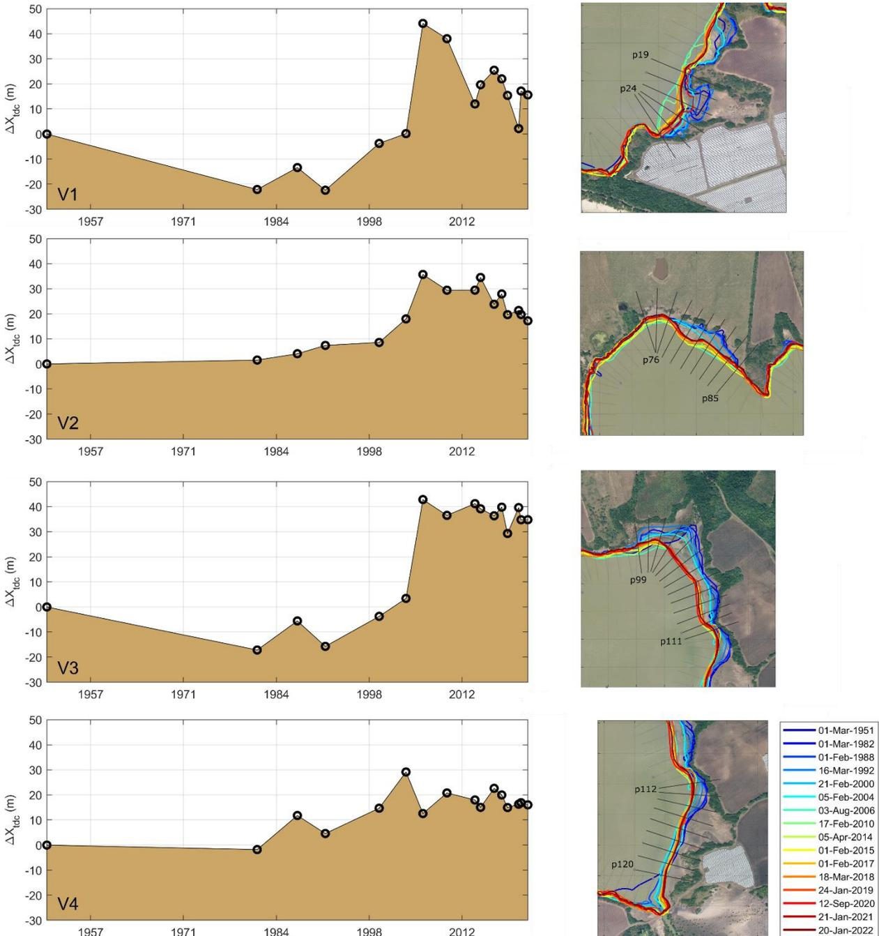
Figure 23 : évolution de la largeur de berge ( $\Delta x_{tdc}$ ) dans la lagune entre 1951 et 2022 moyennée indépendamment pour chacune des zones de vasière (V1-V4). Superposés sur les cartographies à droite, les traits noirs illustrent la localisation des différents profils pour le calcul de largeur (p1 à p120). Fond de carte : BD ORTHO® 2017.
