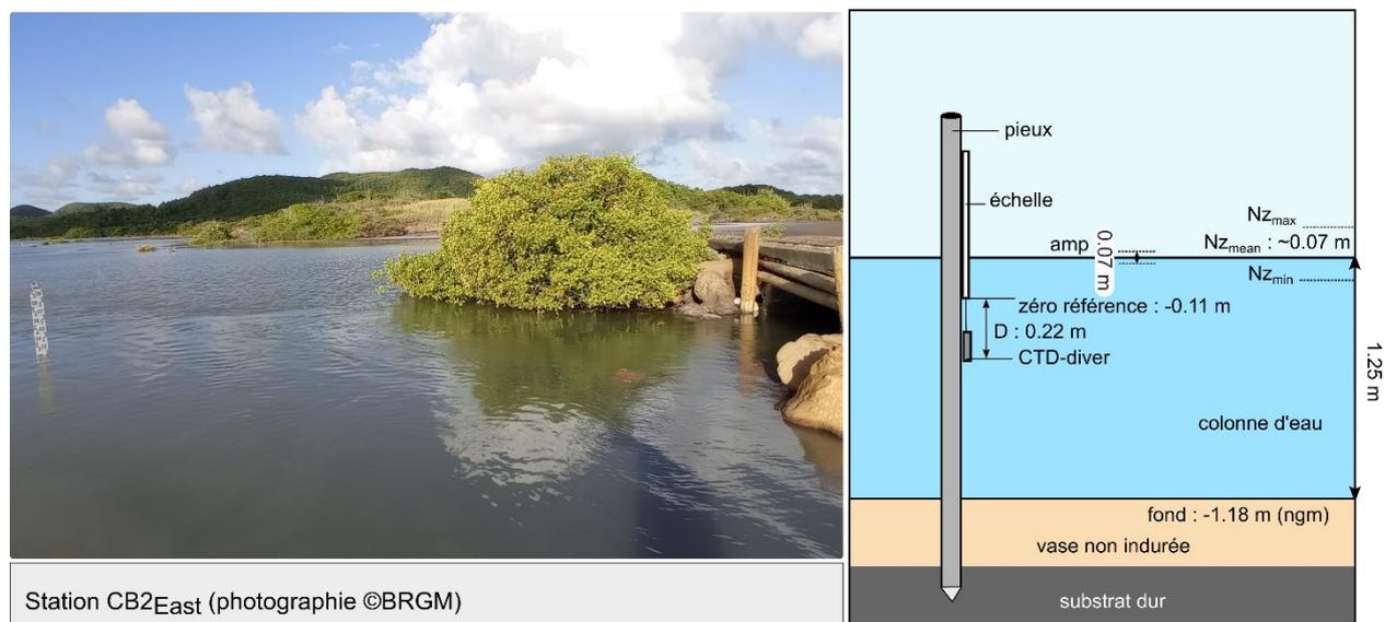
Figure 6 : installation de la sonde CTD diver CB2<sub>East</sub> au niveau de l'entrée (côté étang) du canal sud-est de la lagune.
