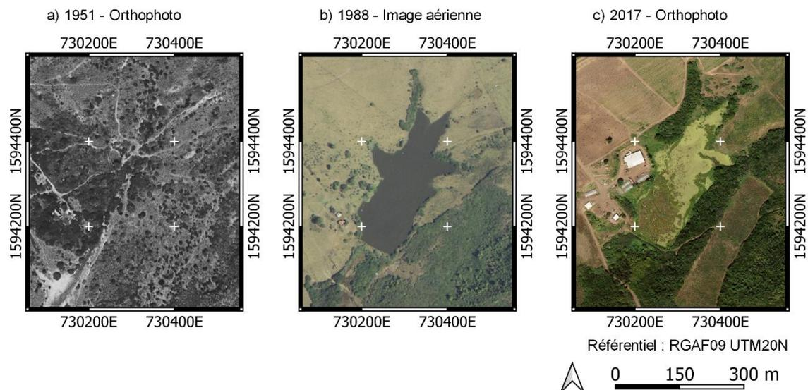
Figure 9 : Evolution de la retenue collinaire située au nord-est de l'étang des Saline, (a) Absence de la retenue en 1951, (b) présence de la retenue avec un rivage bien délimité en 1988 et (c) retenue très eutrophisée mise en évidence par le développement important des algues en surface dès 2017.
