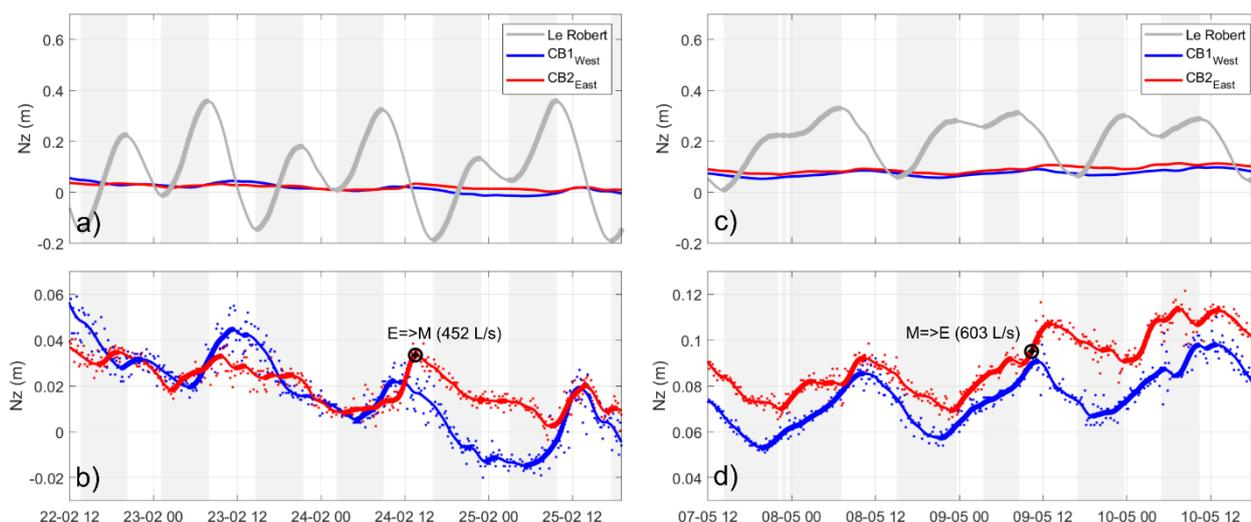
Figure 18: mesures par jaugeage des vitesses d'écoulement à l'entrée (côté lagune) du canal sud-est. Mesures réalisées à marée descendante le 24 février (a-b) et à marée montante le 9 mai 2022 (c-d). Un débit sortant (lagune vers mer) est indiqué par la symbolique E => M. Au contraire, un débit entrant (mer vers lagune) est indiqué par la symbolique M => E.
