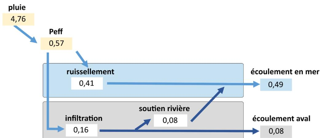
Figure 11 : schéma conceptuel du bilan hydrologique ( $Mm^3/an$ ) à l'échelle du bassin versant de la lagune des Salines. La présence de l'étang défini comme une surface en eau n'est pas prise en compte pour la caractérisation de l'évapotranspiration. La pluie efficace est donc estimée directement à l'échelle du bassin versant.
