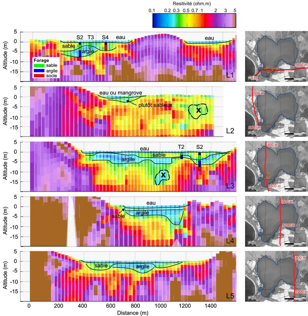
Figure 30 : (à gauche) profil de résistivité selon les lignes de vol L1 à L5 (haut en bas) où sont représentés les différentes formations géologiques. (à droite) Localisation des lignes de vol et points échantillonnés. La distance parcourue le long de chaque ligne de vol est indiquée en rouge (e.g. L1 entre 0 et 1600 m).
