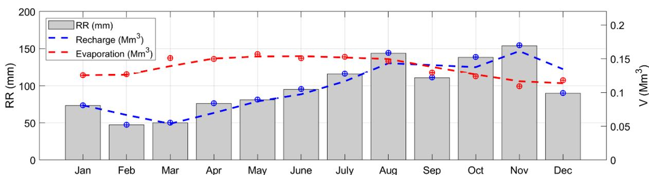
Figure 13 : précipitation (RR en mm) et recharge théorique mensuelle en eau douce (V, en Mm<sup>3</sup>) sur l'étang des Salines. Bilan hydrologique réalisé entre 1991 et 2017 (27 ans).
