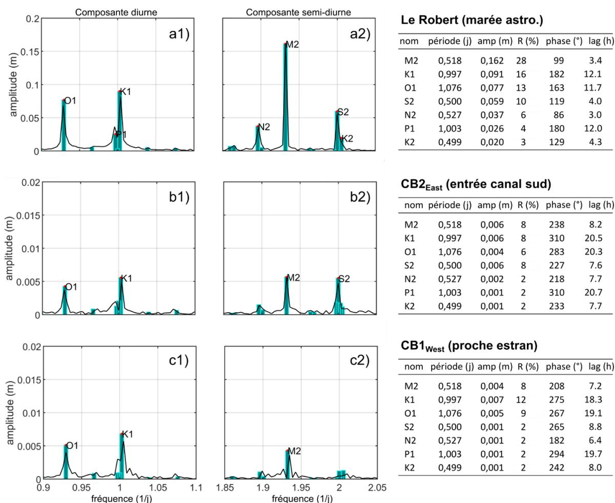
Figure 17 : (a1-c2) - Composantes principales diurnes (à gauche) et semi-diurnes (centre) de la marée en mer au Robert (a1-a2) et dans la lagune aux stations CB2<sub>East</sub> (b1-b2) et CB1<sub>West</sub> (c1-c2). Présentés sur la droite, les paramètres obtenus aux trois stations de mesure décrivent respectivement la période (j), l'amplitude (m) et la phase (°) pour chaque composante de la marée. L'amplitude relative de la marée (R) et le déphasage (*lag* en heure) sont également indiqués.
