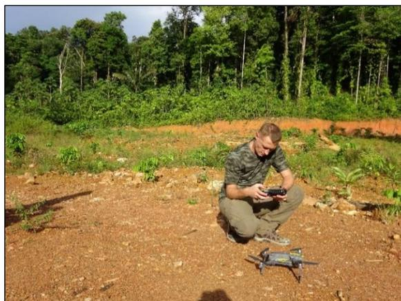
Figure 7 : Drone DJI Mavic Pro 2. Il s'agit d'un modèle à voilure tournante de petite dimension (< 40 cm) pouvant permettre de faire facilement des vols photogrammétriques de reconnaissance dans ce type de contexte (source : BHPPhotoVideo.com, photo : M. Chevillard).
