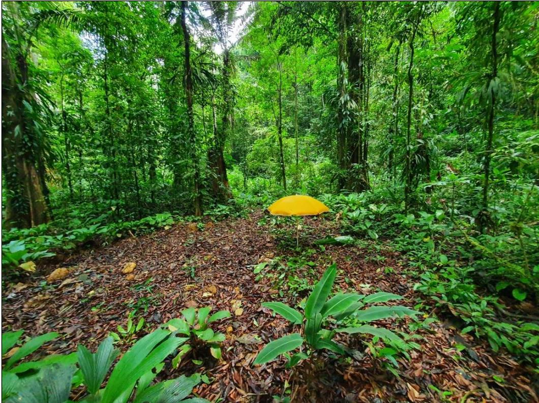
Figure 11 : Technique de validation ayant été testée au cours de la mission. Elle a consisté à placer des parasols dans des zones dégagées, afin de servir à la validation de l'altitude relative des points lidar (photo : T. Dewez). Le sommet du parasol se trouve exactement à 1,50 m du sol.
