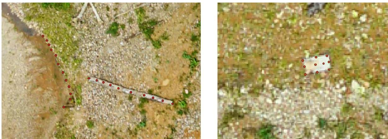
Figure 13 : Position GNSS Trimble (points rouges) validant la position planimétrique de l'orthomosaïque. Les détails employés : rebord abrupt de berge, extrémités et points axiaux d'un tronc d'arbre, bordure d'un réservoir métallique montre la parfaite adéquation de la position entre l'orthophoto et les points de contrôle.
