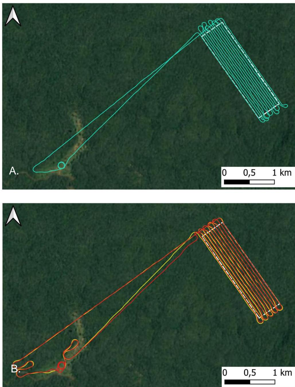
Figure 10 : Trajectoire des vols Trinity réalisés sur Valentin le 12 octobre. A. Vol photogrammétrique. B. Vols lidar. Source : L'Avion Jaune.
