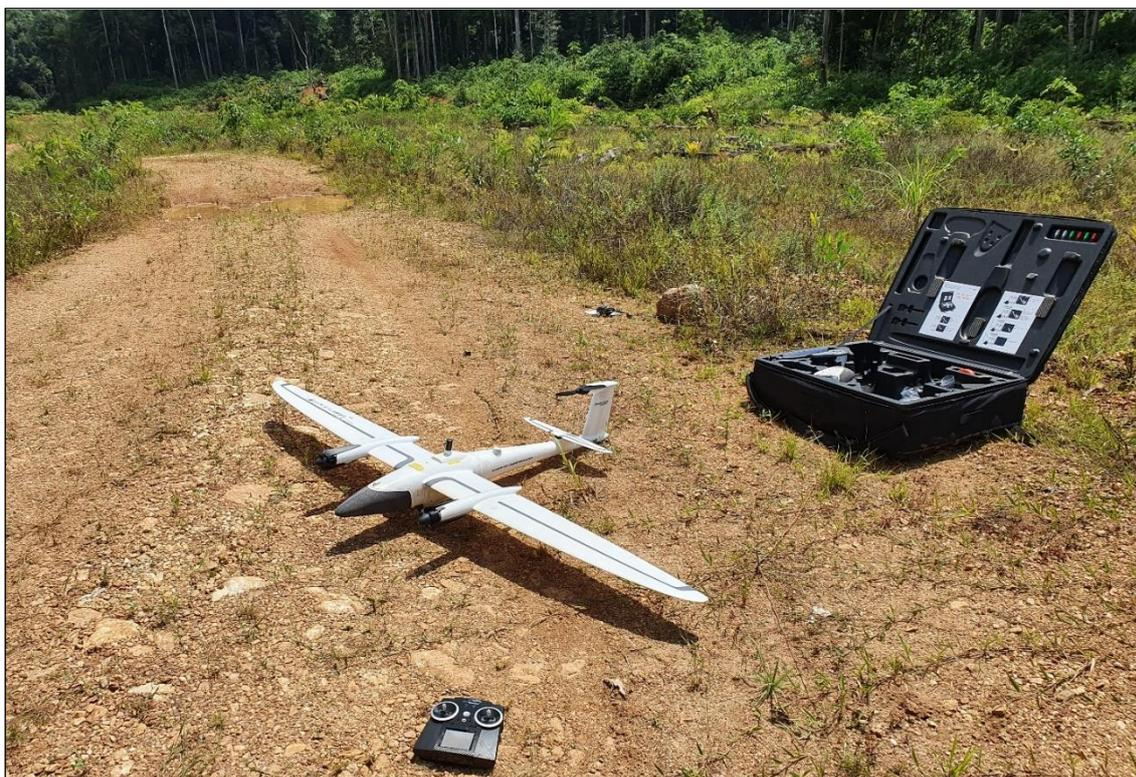
Figure 4 : Drone Quantum Trinity F90+ sur son aire de décollage (photo : T. Dewez). Malgré une envergure de 2,40 m, le drone se loge démonté dans la valise à l'arrière-plan. La batterie de 64,8 Wh permet de voler pendant 1h en alimentant le lidar Yellowscan Qube240.
