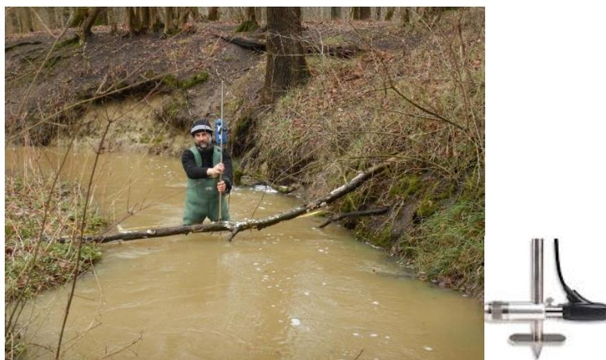
Figure 13 : Mesure du débit de la Retrève au courantomètre MF-Pro, à Ambert (M3bis), le 01/02/2021 (© BRGM).
