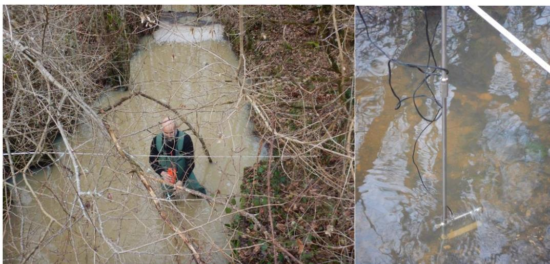
Figure 12 : Jaugeage au micromoulinet à Grand Pont (Orfosses mouillées) – Point M1 le 01-02-2021.
