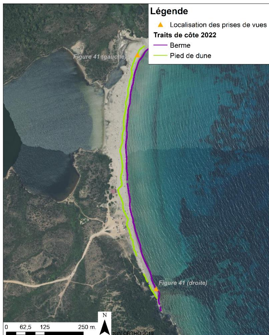
Figure 39 : Linéaire levé pendant la campagne du ROL 2022 à Balistra.
