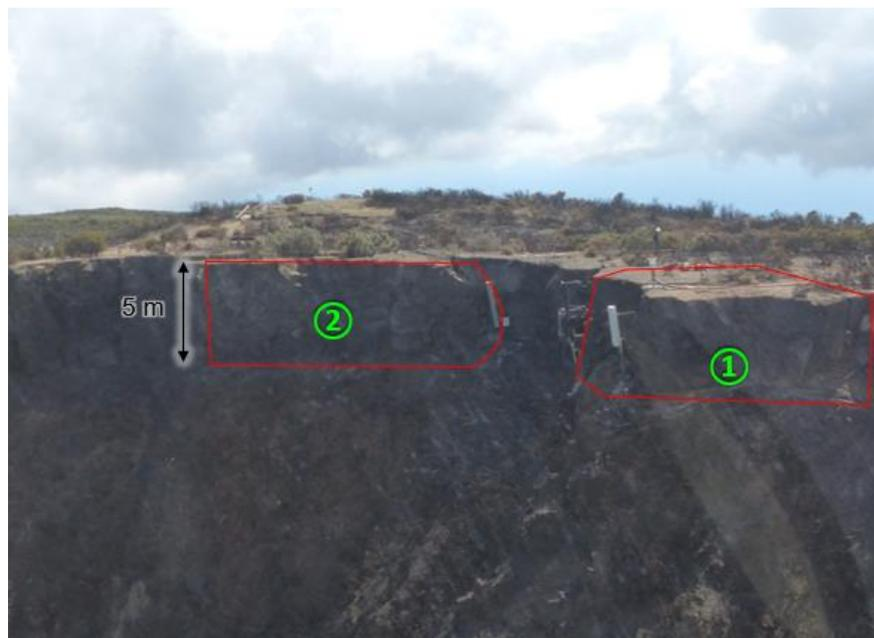
Figure 14 – Découpages de compartiments rocheux sur la zone des antennes et localisation du témoignage d'aggravation supposée de l'ouverture d'une fissure entre le 9 et le 13/11/2020, compartiment 1 et 2 (cercles verts) localisés sur la Figure 7.
