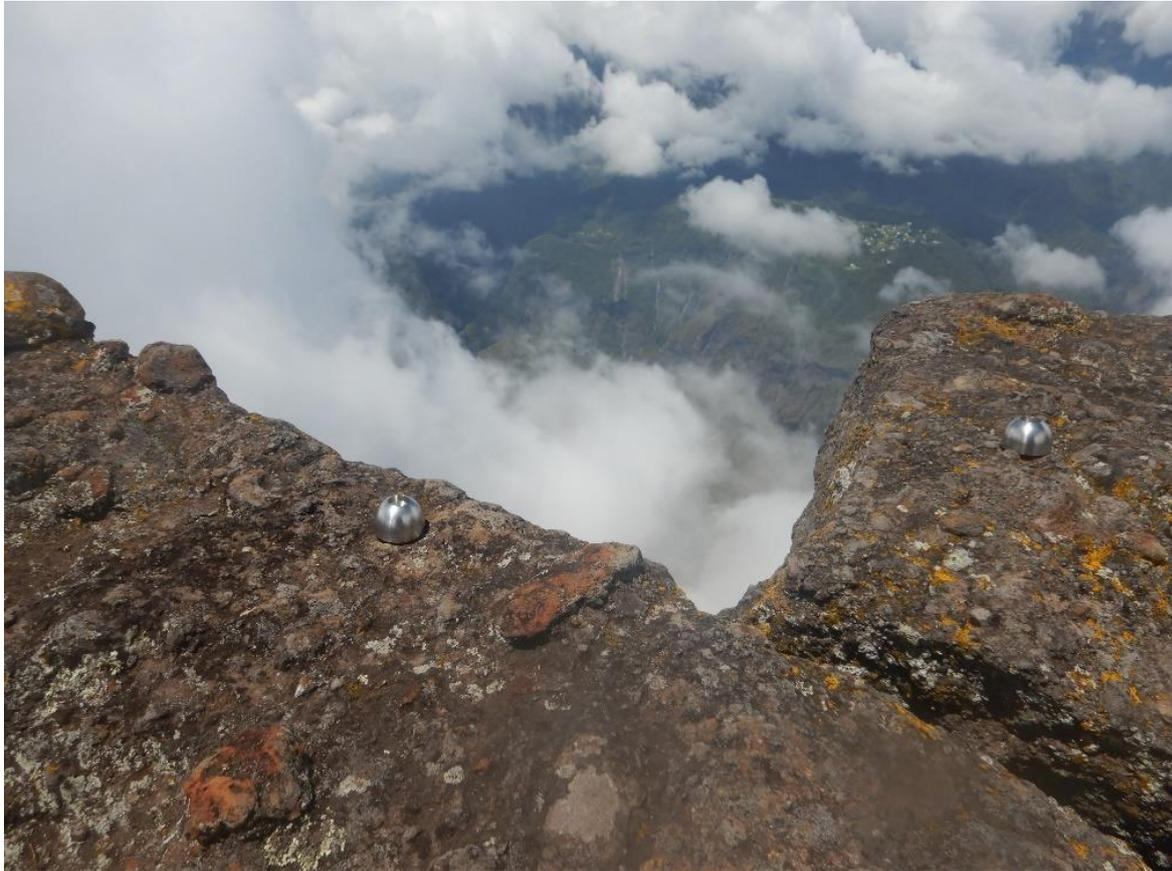
*Figure 43 : Paire de jauges de déplacement installée en 40 points pour des mesures périodiques de l'ouverture de fissures avec une précision de l'ordre du dixième de millimètre.*
