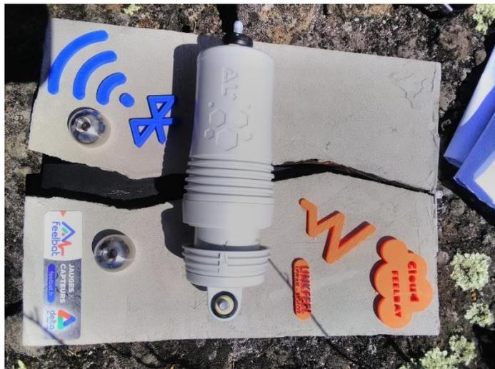
Figure 42 : Capteur de type Delta L+ de la marque Feelbat installé en 12 points pour des mesures en continu de l'ouverture de fissures avec une précision de l'ordre du dixième de millimètre et télétransmission des données.
