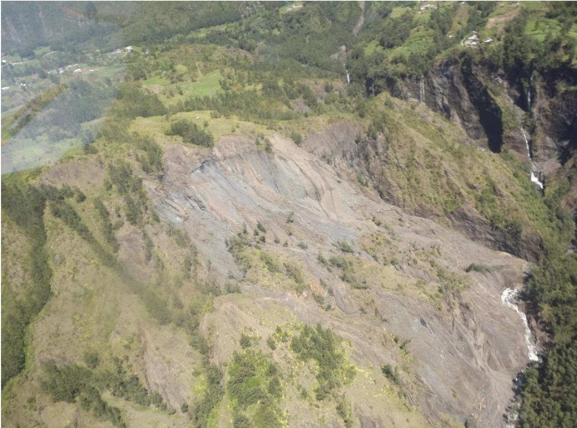
Figure 25 – Glissement de la bordure Est du plateau de Grand Ilet lors de Bêjisa en 2014 (volume estimé 1 million de m<sup>3</sup>).
