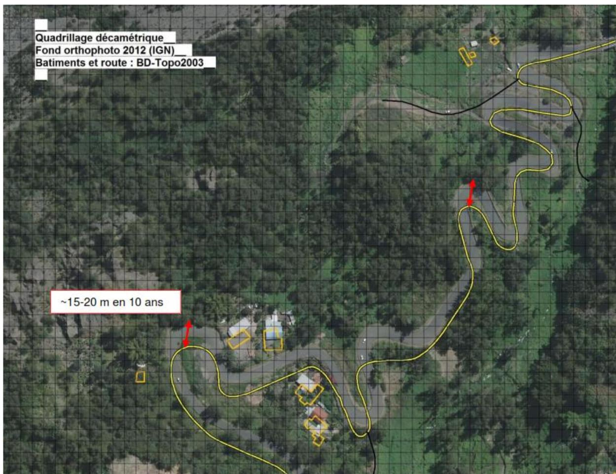
Figure 40 – Impact du glissement de Fond de Rond Point sur les terrains au niveau de Mare à Poule d'Eau, avec un déplacement de 15 à 20 m en 10 ans sur ce secteur.
