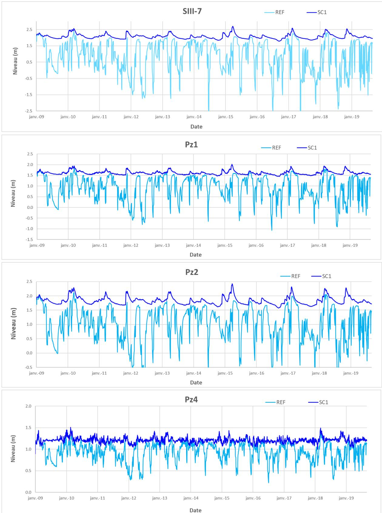
Illustration 68 - Impact du scénario SC1 sur les niveaux piézométriques du puits de pompage SIII-7 et des piézomètres Pz1, Pz2 et Pz4 (2009-2019), nappe captive.
