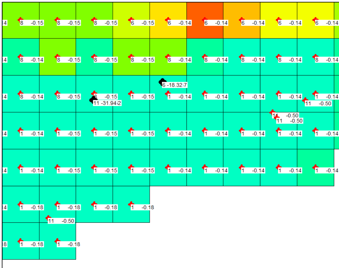
Illustration 16 – Prélèvements uniformisés d'eau souterraine (forages activés post 1999 en rouge) considérés dans le modèle hydrogéologique maillé de l'Authion.
