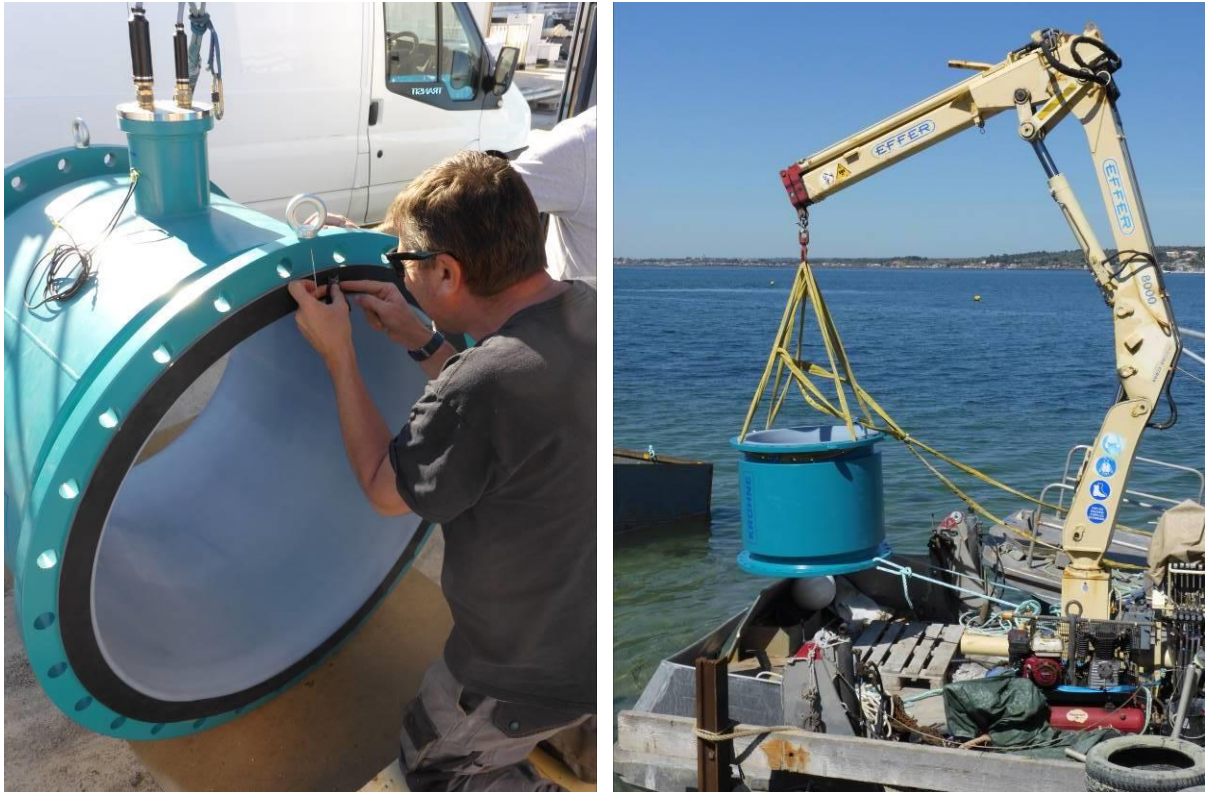
Illustration 8 : Le débitmètre avec ses connecteurs étanches, et prêt à être transporté sur zone.
