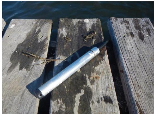
*Illustration 95 : Détails de la sonde installée pour le suivi du niveau de l'étang au Fortin.*
