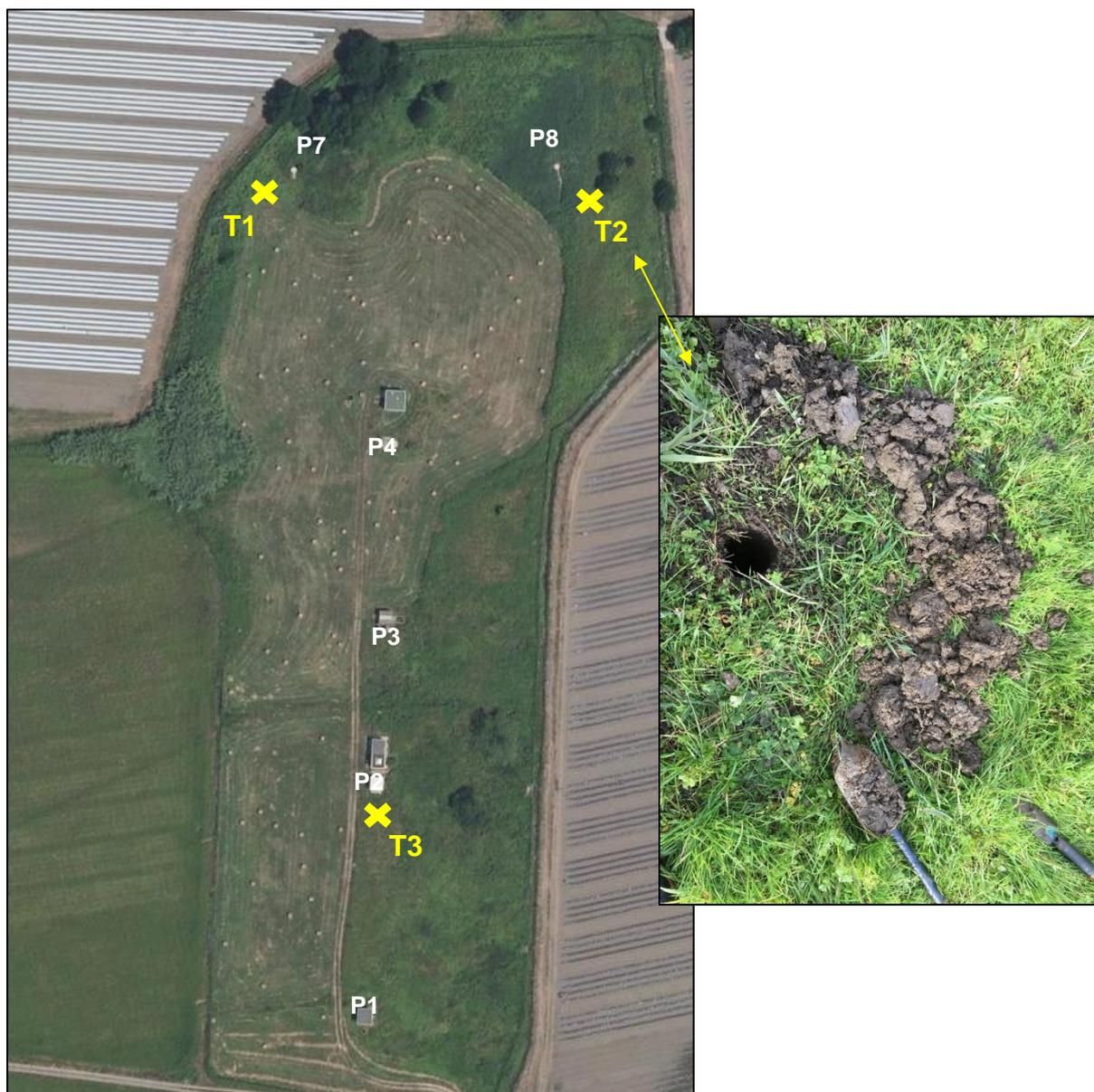
*Illustration 122 : Localisation des trous à la tarière (T1, T2, T3) réalisés sur le champ captant le 11/12/2020 et photographie des échantillons de limons bruns sur T2 extraits.*
