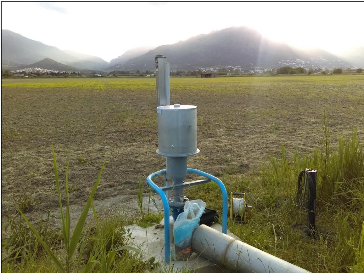
*Illustration 93 : Photographies du mini-piézomètre "LIM1" implanté à proximité immédiate de Pz1.*
