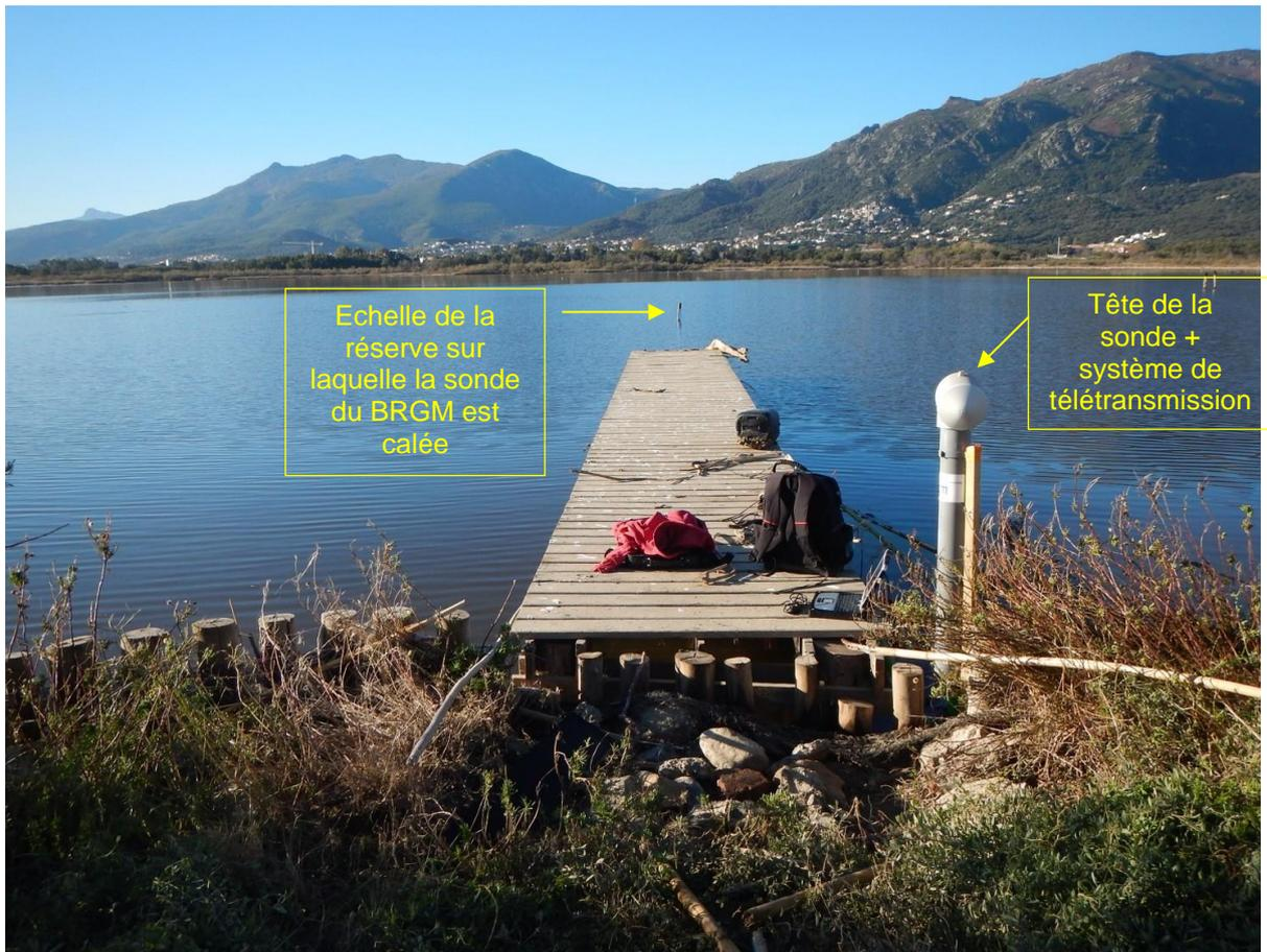
Illustration 94 : Photographie du système de suivi du niveau de l'étang mis en place sur le ponton du Fortin.
