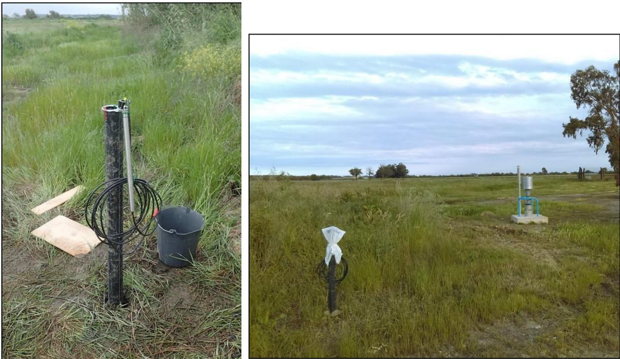
*Illustration 92 : Photographies du mini-piézomètre "LIM5" implanté à proximité immédiate de Pz5.*
