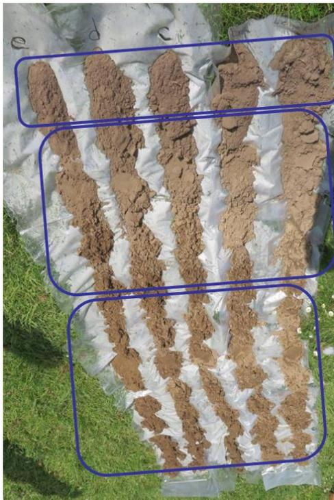
*Illustration 13 : Principe d'échantillonnage sur profils de sols composites*
