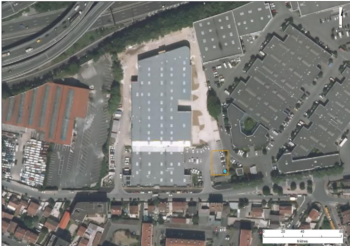
Illustration 2 : Localisation du piézomètre (point bleu) au droit du Centre Technique Municipal de la Courneuve, en orange emprise au sol durant les travaux. Source : Orthophotographie IGN
