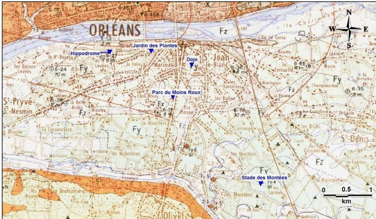
*Fy, Fz : alluvions récentes, Fw : alluvions anciennes, X : Dépôts artificiels, g3 : calcaires de Beauce*
