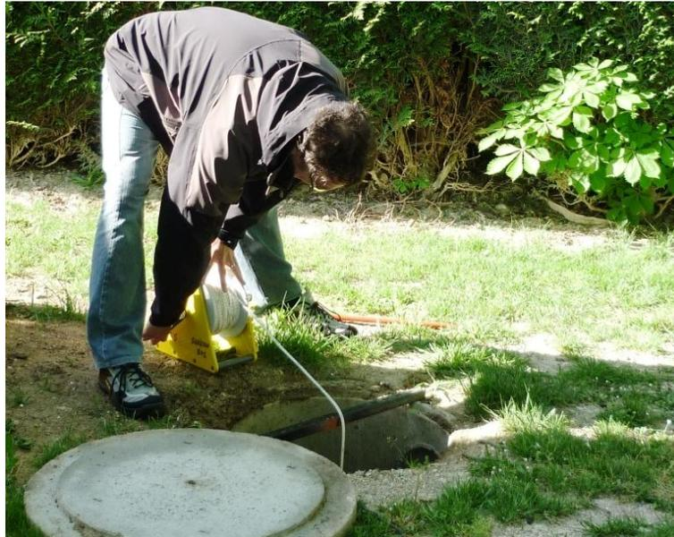
Illustration 3 : Mesure du niveau de la nappe – piézomètre de l'Hippodrome (cliché BRGM).
