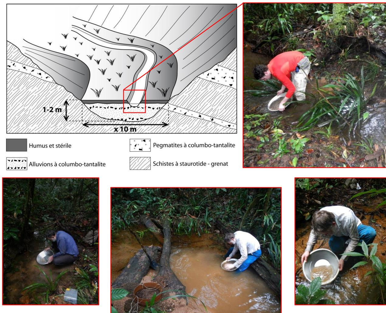
Fig. 3 – Échantillonnage des flats à columbo-tantalite par prélèvements alluvionnaires en lit vif.
