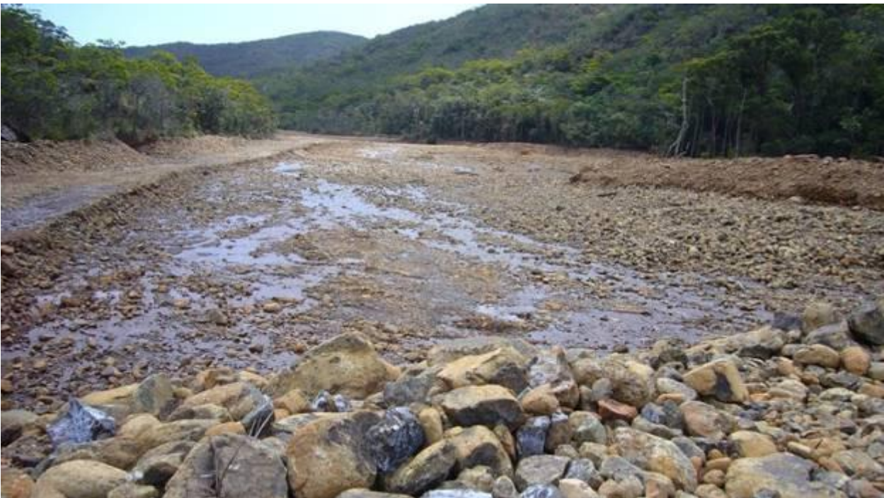
Illustration 61 : Vue vers l'aval prise du front de l'exploitation de granulats sur la Oue Tanquéa (Pt103). À noter les sorties d'eau dans les alluvions exploitées.
