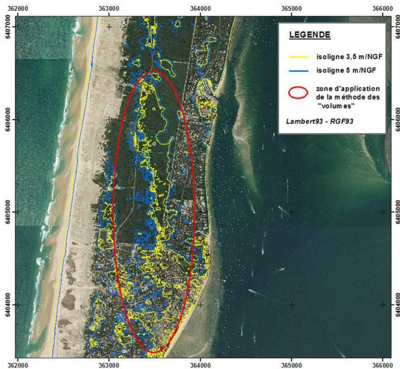
Figure 17 : Zone basse de « Morava » sur la commune de Lège-Cap-Ferret concernée par la méthode « topo/volume ».
