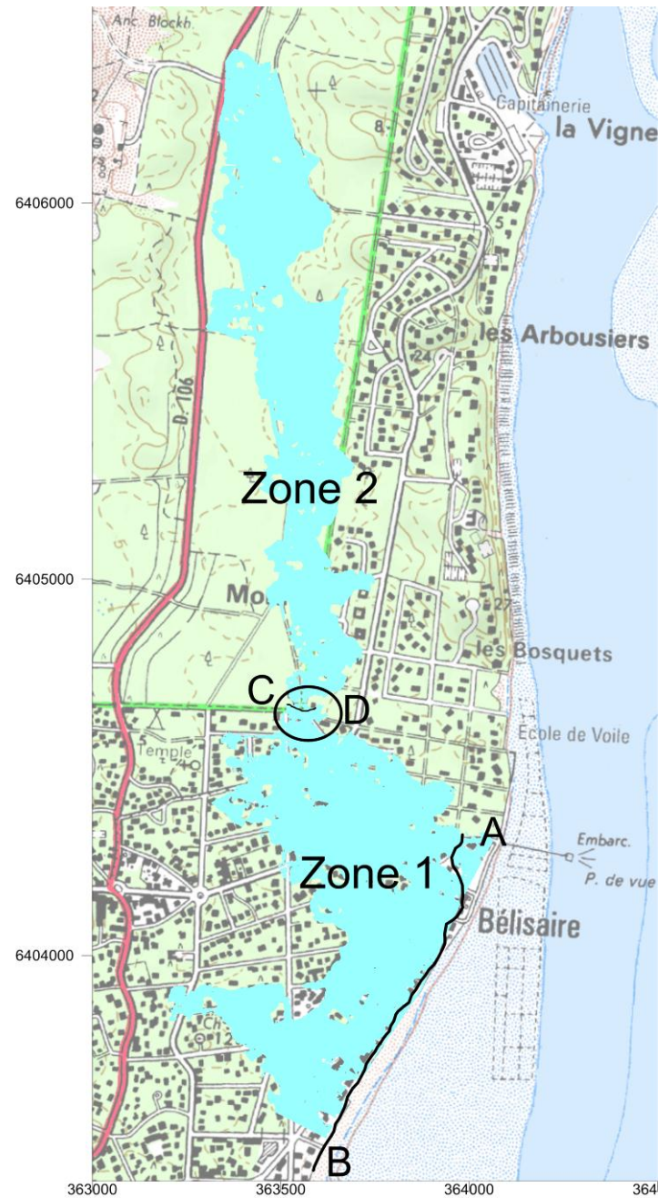
Figure 41 : Surfaces potentiellement inondables sur le secteur de « Bélisaire - Morava » (terrains situés sous la cote 3,80 m/NGF). La ligne (A-B) correspond à la ligne de débordement. Les zones 1 et 2 sont séparées par un seuil topographique (C-D).
