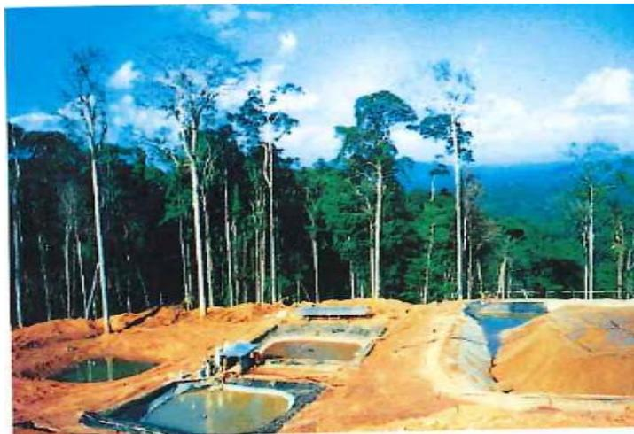
Figure 10 : mine de changement. Pilote de traitement du minerai par cyanuration en tas.
