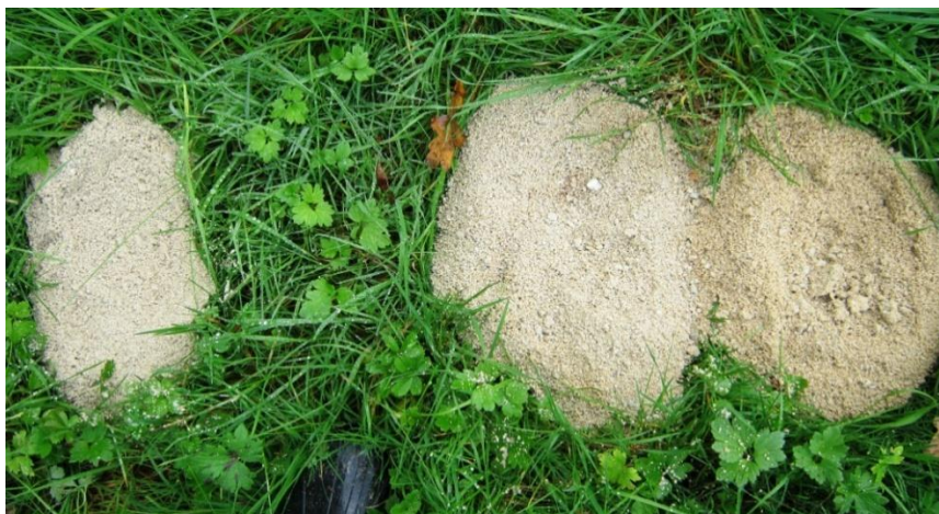
Figure 5 : photo des cuttings (profondeur 9 à 12 m) – sables kaoliniques
