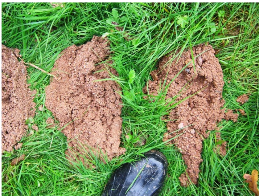
Figure 6 : photo des cuttings (profondeur 38 à 41 m) – sables grossiers à teinte violacée
