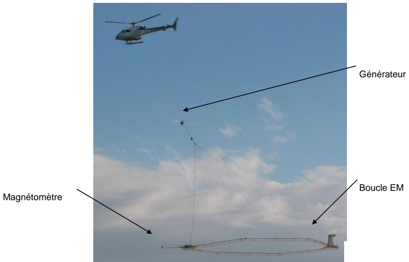
Figure 4 - Photographie du système SkyTEM en vol.
