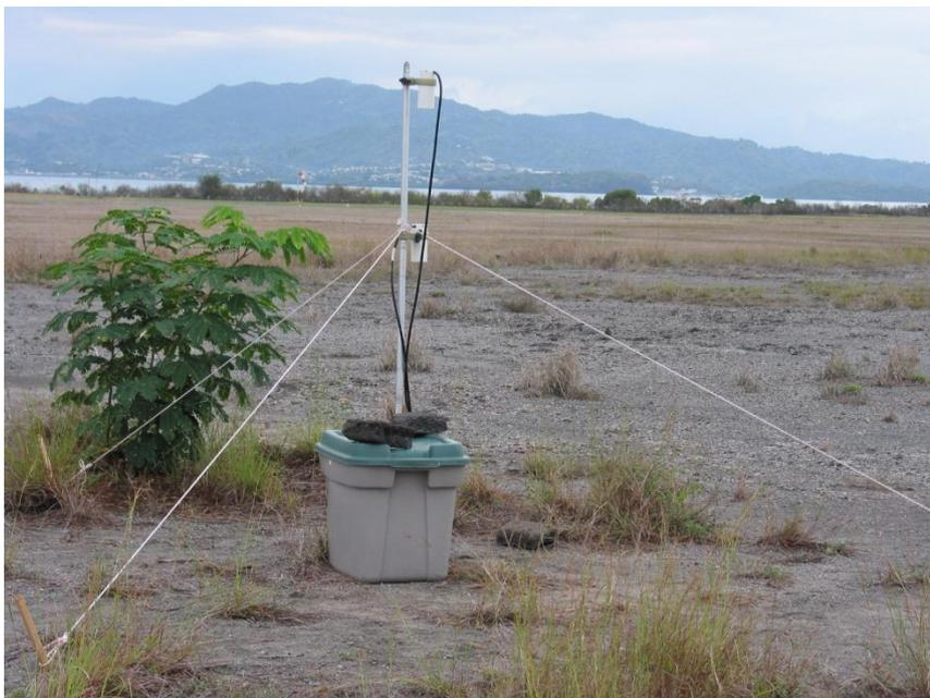
*Figure 5 - Station magnétique au sol installée pour le lever géophysique à l'aéroport de Dzaoudzi.*
