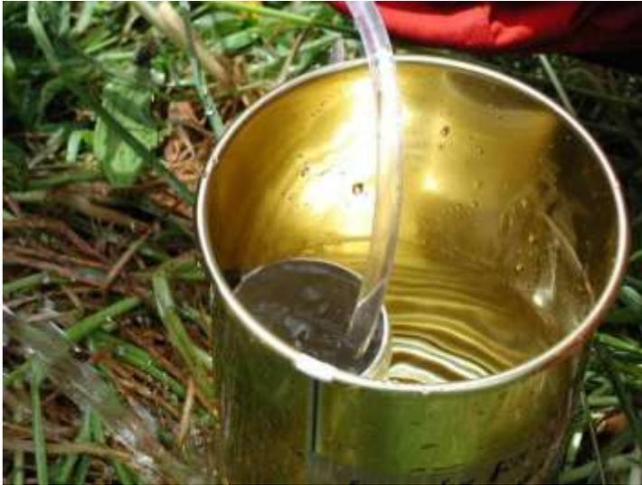
*Illustration 18 : Système de prélèvement utilisé pour les CFC et SF<sub>6</sub>*
