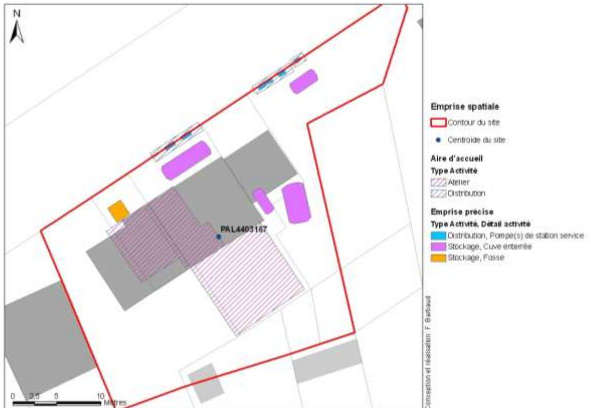
Illustration 12 – Exemple d'intrasite digitalisé sur une ancienne station service.
