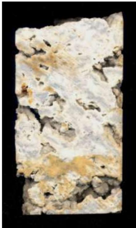
Figure 40 : Faciès et porosité de la Dolomie de Mano du Tithonien carottée à 1 148 m de profondeur dans le sondage d'exploration Trensacq 1
