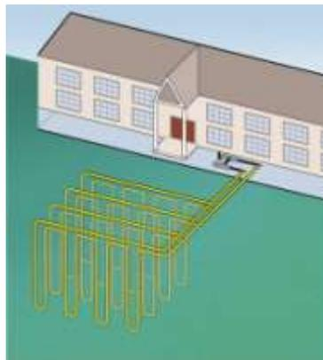
Figure 8 : Schéma d'un champ de sondes géothermiques
