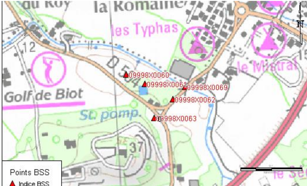
Illustration K : Projection cartographique des points BSS situés à proximité du point considéré (code BSS : 09998X0061/HY)
