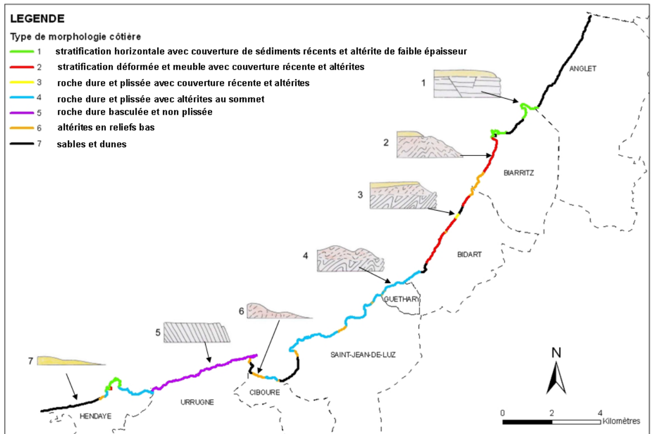
Illustration 27 : Type de morphologie côtière sur la côte rocheuse
