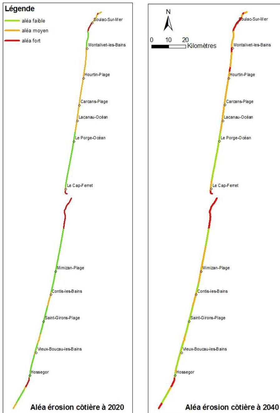
Illustration 13 : Cartographie de l'aléa érosion côtière sur la côte sableuse aux horizons 2020 et 2040
