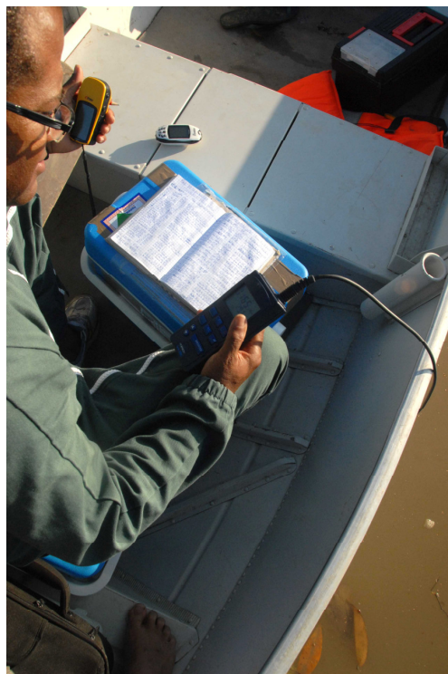
Figure 2 : mesure de la conductivité depuis l'embarcation
