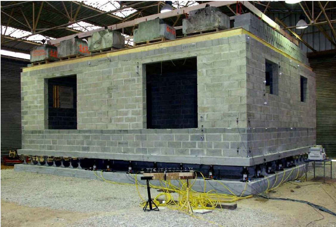
Illustration 1 – Maquette de maison en vraie grandeur construite au CER de Rouen (LCPC)
