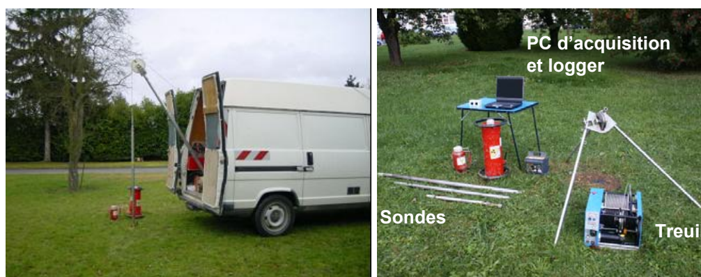
Illustration 7 - Atelier de mesures in situ de diagraphie nucléaire (LCPC)
