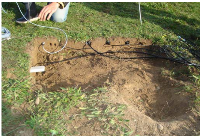
Illustration 6 – Implantation des capteurs étudiés dans une fosse (Météo France)
