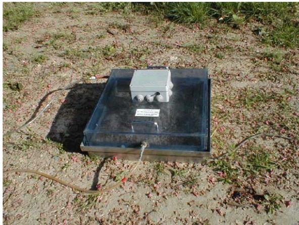
Figure 16 : Chambre à recirculation externe utilisée (INERIS)
