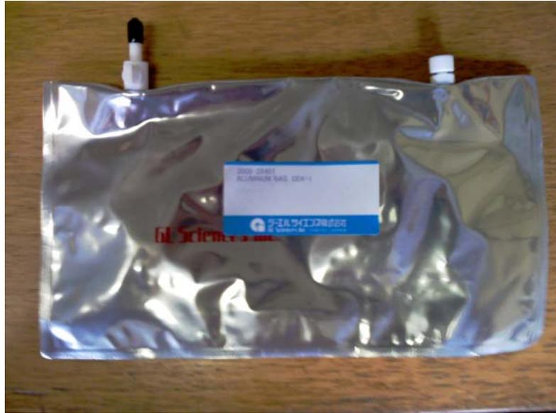
Figure 22 : Sac nylon-aluminium-polyéthylène pour les prélèvements de gaz
