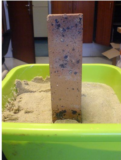
Figure 134 - Position de la brique sur un sol non liquéfié
