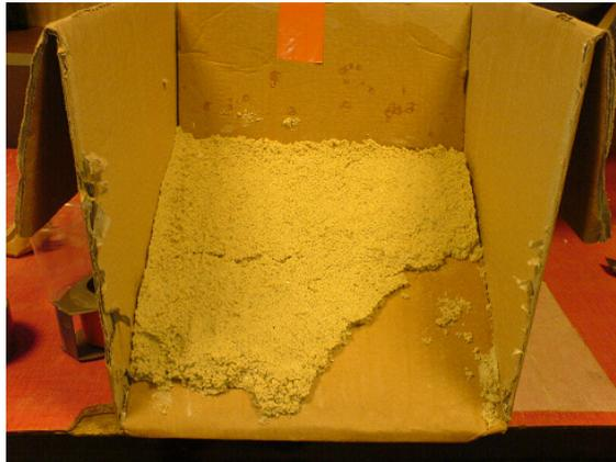
*Figure 139 - Glissement de sable humide après l'application de secousses*
