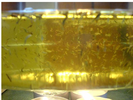
Figure 21 - Cellules de convection observables grâce aux mouvements du thym
