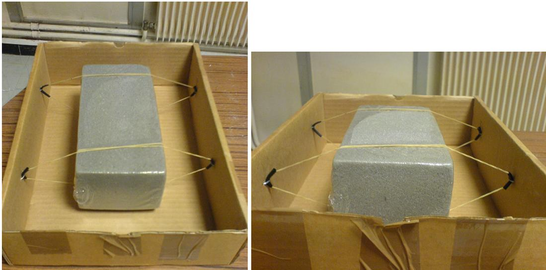
Figure 177 - Montage d'une table sismique
