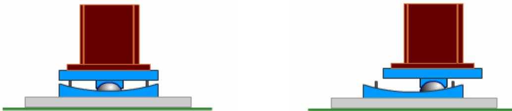
*Figure 167 - Supports à bille : deux plaques connectées par une boule en métal peuvent glisser horizontalement grâce au roulement de la bille, mais elles résistent très bien à la charge verticale (poids du bâtiment) – Source : Earthquake Engineering Research Centre at the University of Bristol*
