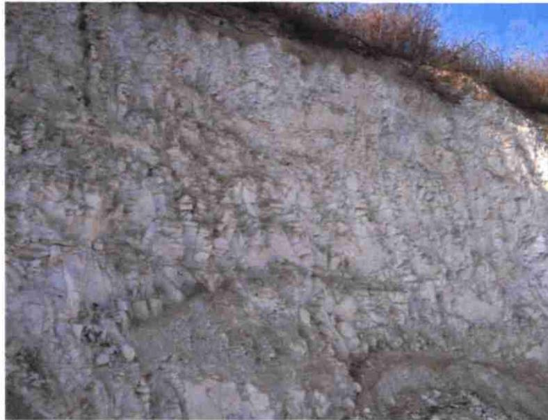
Photo 1 : Exemple de fracturation de la craie
