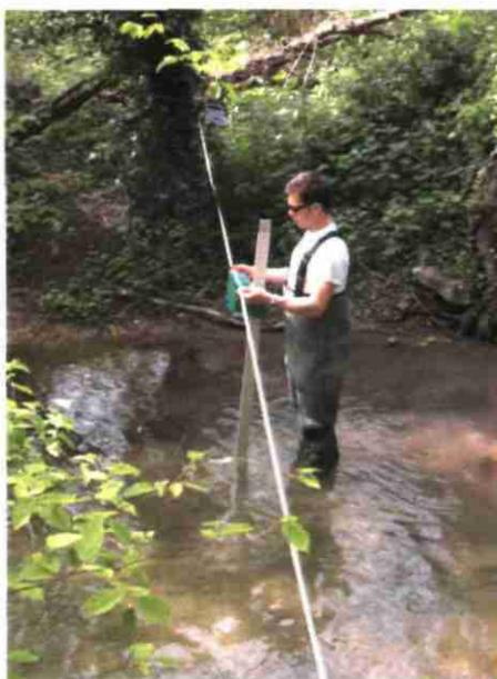
*Photo 3 : Exemple de jaugeage à l'aide d'une perche à intégration*
