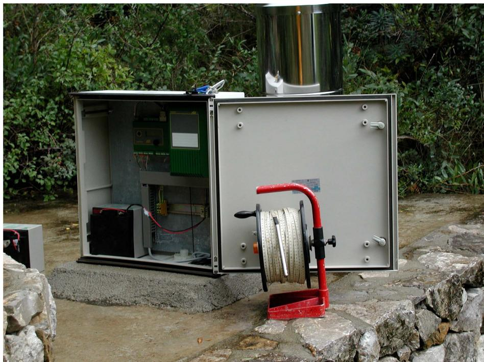
*Illustration 39 - Coffret avec centrale d'acquisition pour la source et le pluviomètre, ainsi que batterie à la source de la Mouillère.*
