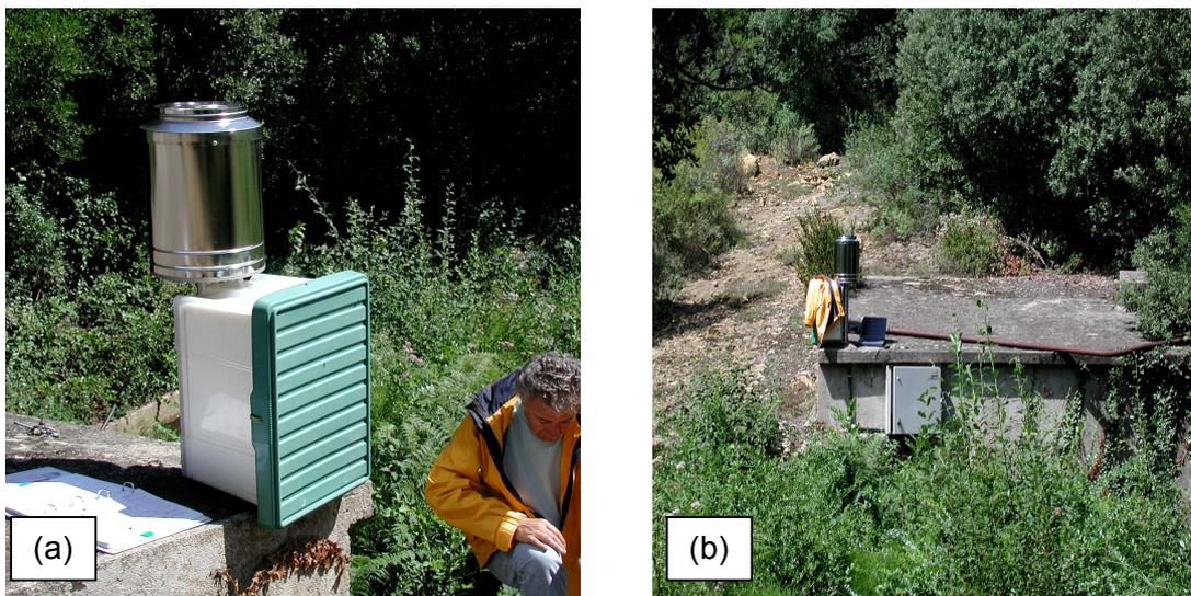
*Illustration 59 - (a) Pluviomètre permettant l'échantillonnage des pluies au niveau du toit du captage de la source du Verdouble et (b) coffret de la centrale d'acquisition des paramètres enregistrés à la source et au pluviomètre.*
