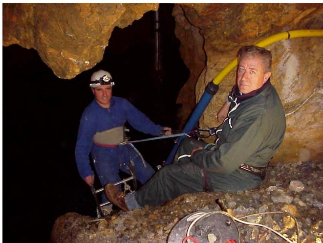
*Illustration 48 - Installation du câble dans une gaine de protection, assurant la liaison entre les sondes et la centrale d'acquisition.*
