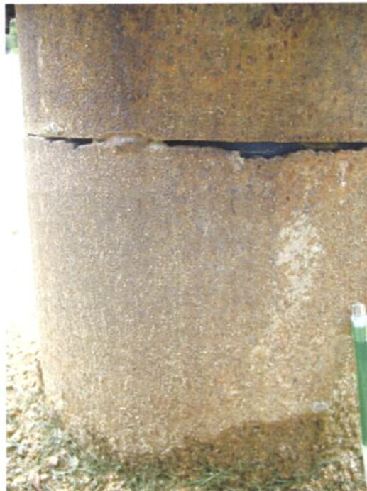
**Photo 5 - Joints défectueux au niveau du forage Magnolia**
