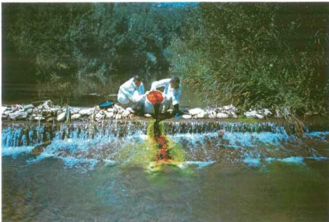
Photo 3 : Injection du premier des quatre bidons sur le seuil...
