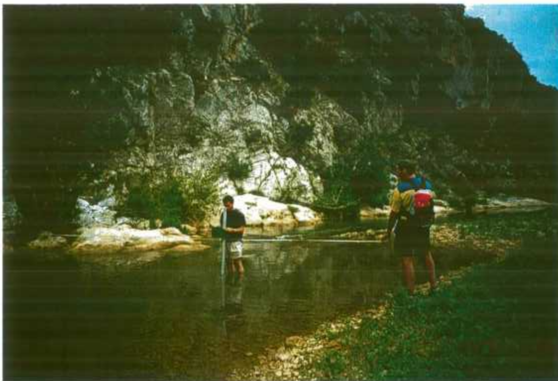
Photo 1 : Jaugeage du Verdoube le 18/07/2002 (profil n°4, cf. Fig. 4).
