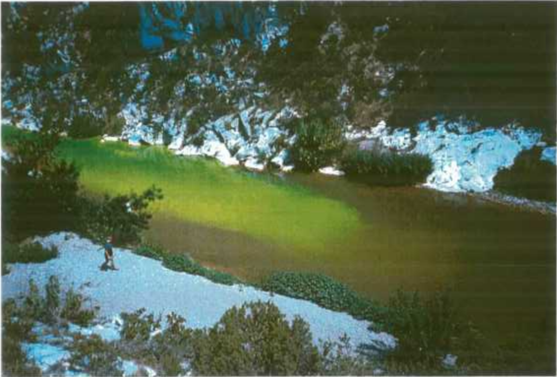
Photo 5 : Panache de fluorescéine à l'arrivée dans la vasque...
