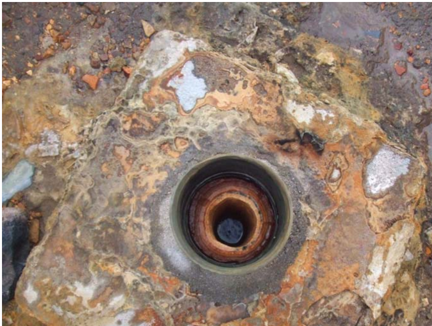
Illustration 27 - Dépôts carbonatés dans le forage II (ou Ranomafana V)
