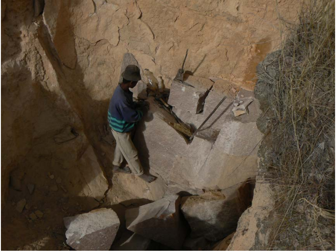
Photographie 4 - Carrière de granite exploitée artisanalement (site 10, cliché BRGM)
