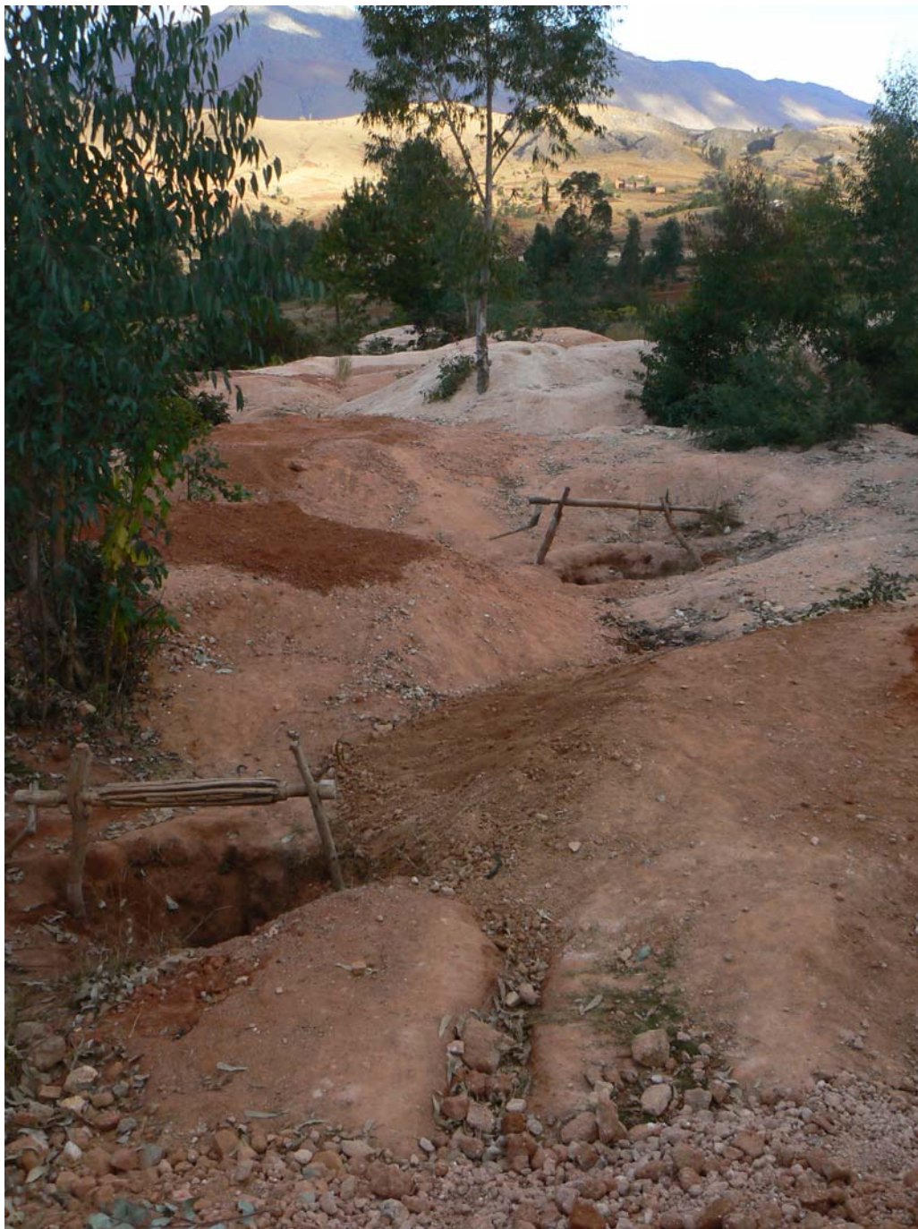
Photographie 3 - Vue d'une zone d'exploitation de filons de pegmatites pour extraction de la tourmaline et du béryl (site 6, cliché BRGM)
