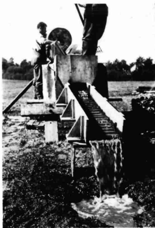
le sluice et ses riffles
