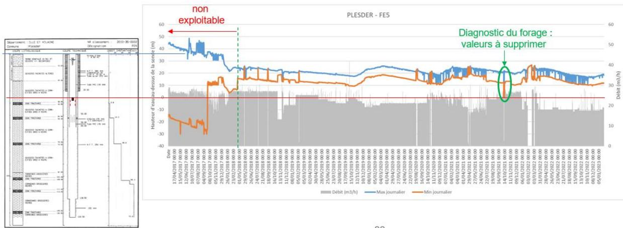
Illustration 38 : Evolution du niveau piézométrique et du débit sur le forage de la Ferrière FE5 entre 2017 et 2023 (source : seQoya) et comparaison à la coupe de l'ouvrage. En rouge : niveau de la sonde de mesure
