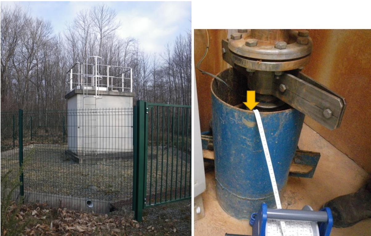
*Illustration 33 : Tête du forage de la Ferrière. La flèche jaune indique le repère de mesure (photographies BRGM – 03/03/2023)*
