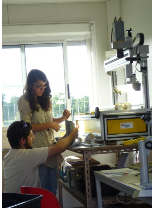
Figure 17 : Le banc « DMT », à scanner les carottes, est relié à un logiciel permettant le traitement d'image, avec au final la reconnaissance et l'orientation de structures géologiques (failles, fractures, stratifications...). Les carottes du socle ont dû être renforcées pour passer sur le banc.
