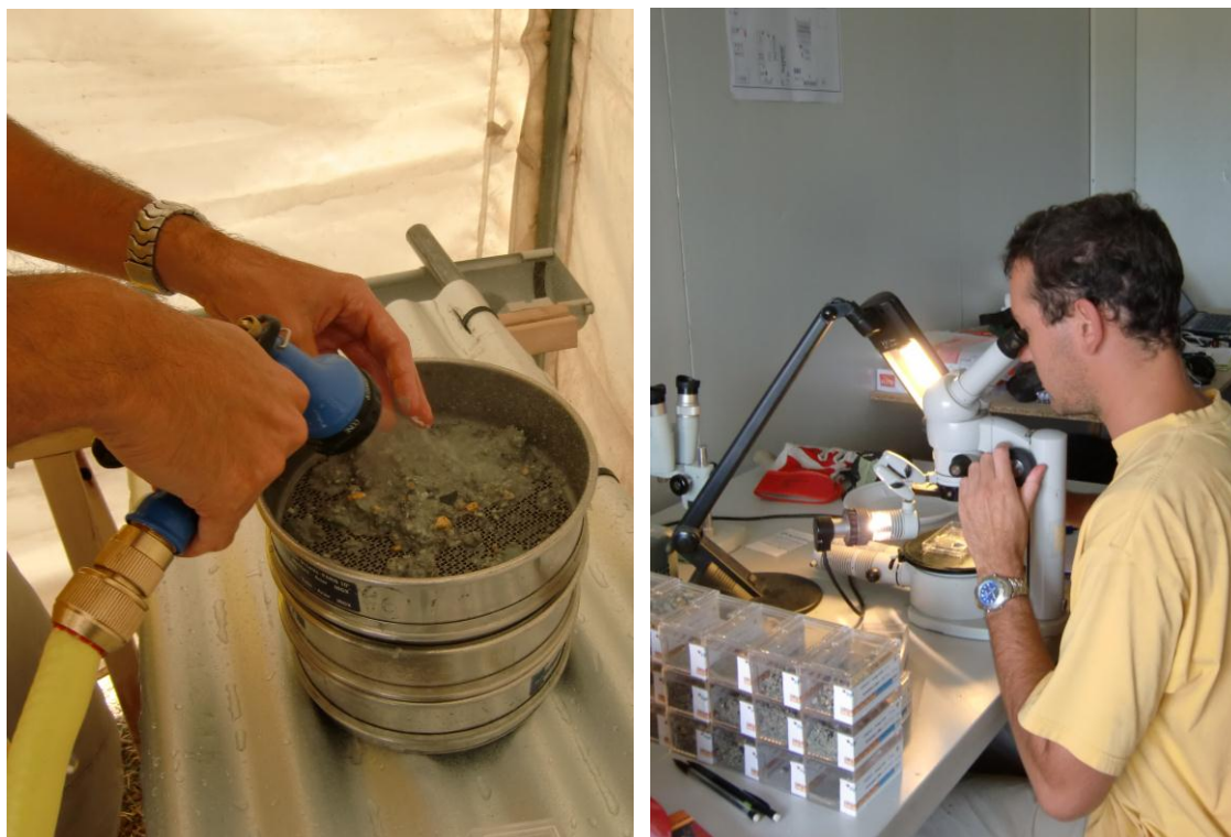
Figure 13 : Gauche : tamisage d'un cutting sur la pile de tamis. Droite : les refus de tamis sont conditionnés dans des boîtes plastiques, leur contenu étudié à la loupe binoculaire.
