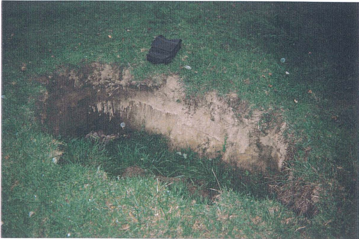
Photo 11 : Ueberstrass - Point N° 11 - Fontis de 2 m x 1 m de profondeur : Un 2 ème fontis, plus petit se situe à 5 m à droite de la photo
