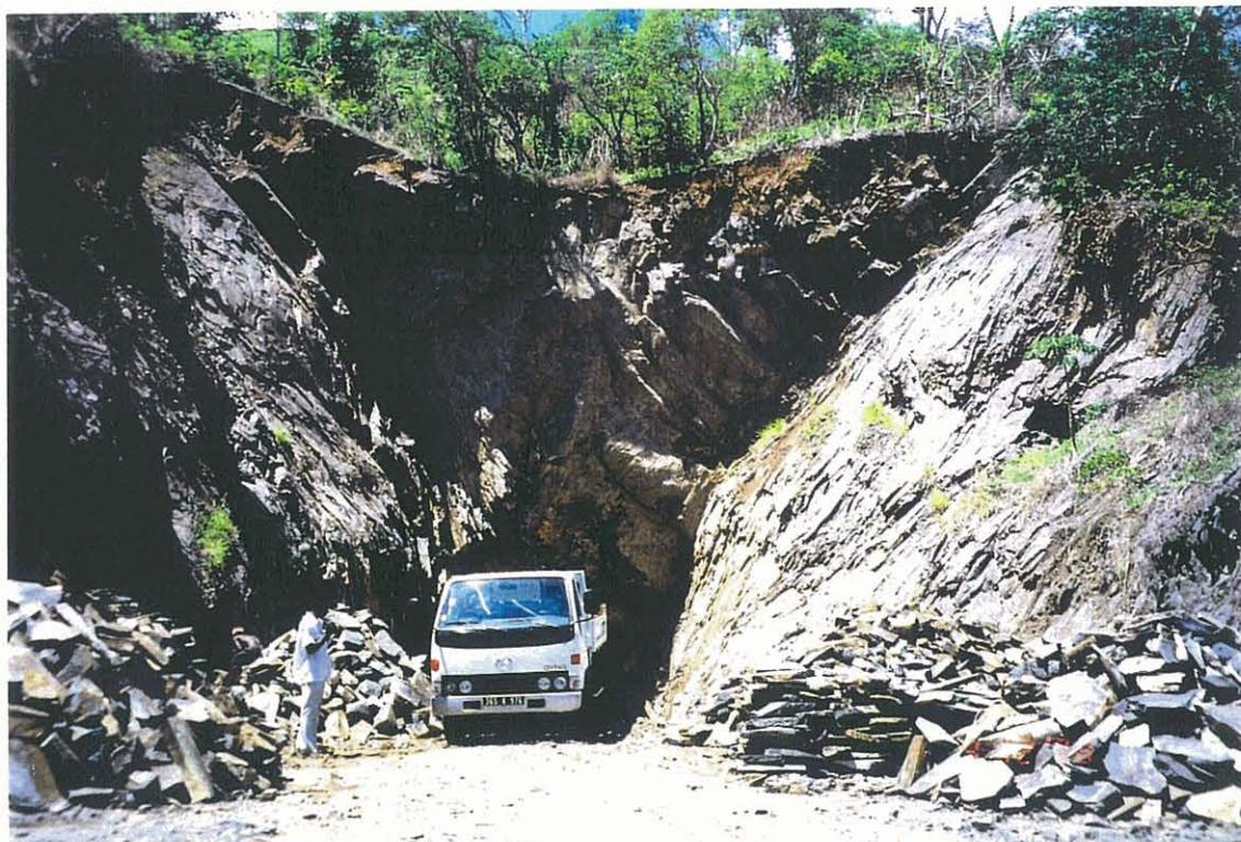
**Photo 3 : Coulée basaltique de vallée (noter la morphologie en V) servant à la production artisanale de pierres plates (site n° 8)**
