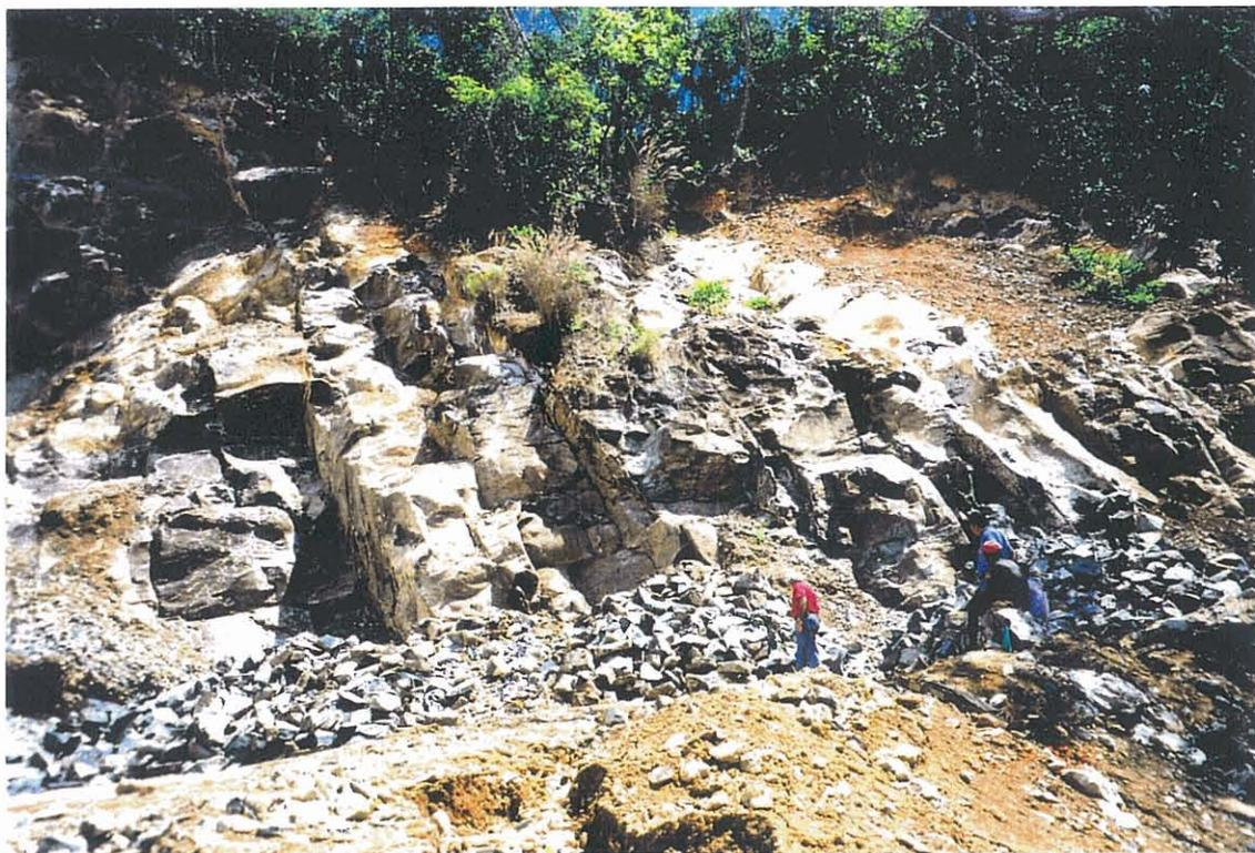
**Photo 5 : Gisement de phonolite présentant des bancs métriques redressés, exploité artisanalement pour la production de blocs (site n° 9)**
