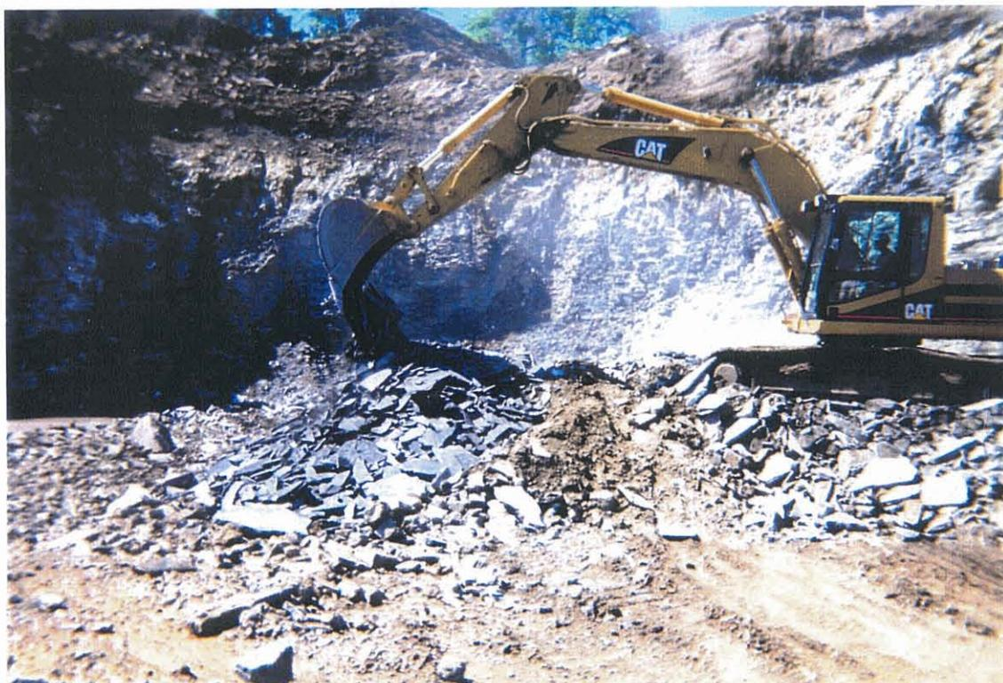
**Photo 2 : Carrière de Majicavo Lamir, exploitée par IBS, montrant un débit en "lauzes" du basalte (site n° 1)**
