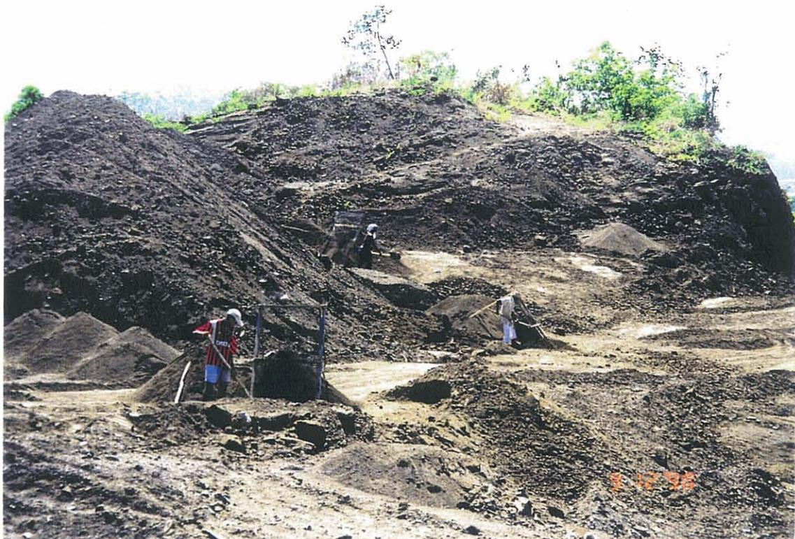
**Photo 27 : Criblage des matériaux de la carrière de Kaouéni (site n° 16)**
