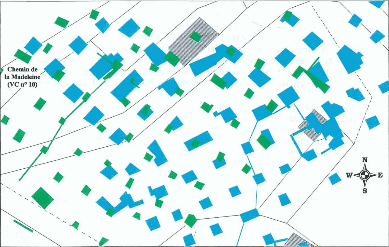
Figure 26 : Superposition des levés topographiques des niveaux supérieur et inférieur sous le chemin de la Pège et sous le chemin de la Madeleine, montrant la disposition anarchique des piliers d'un niveau à l'autre Positionnement sur fond cadastral
