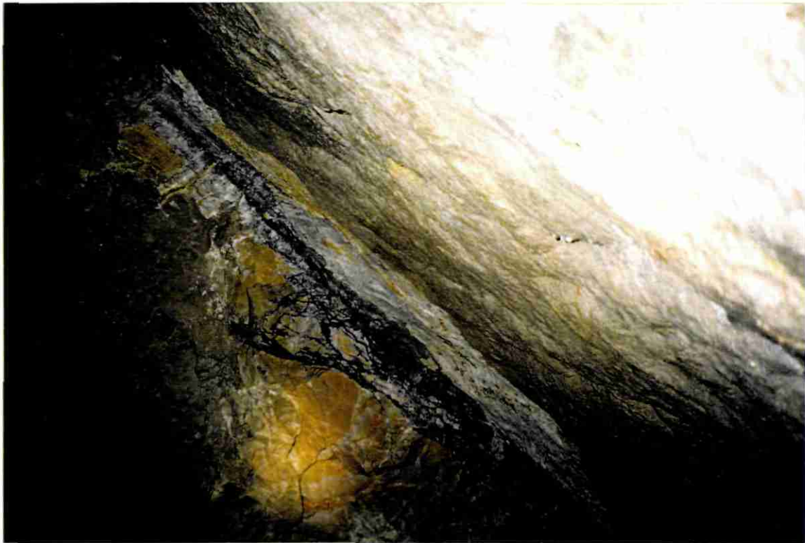
Ph. 1 - Mine du Fournel, veine minéralisée et faillée (station n° 49 B, Travaux Saint-Roch).
