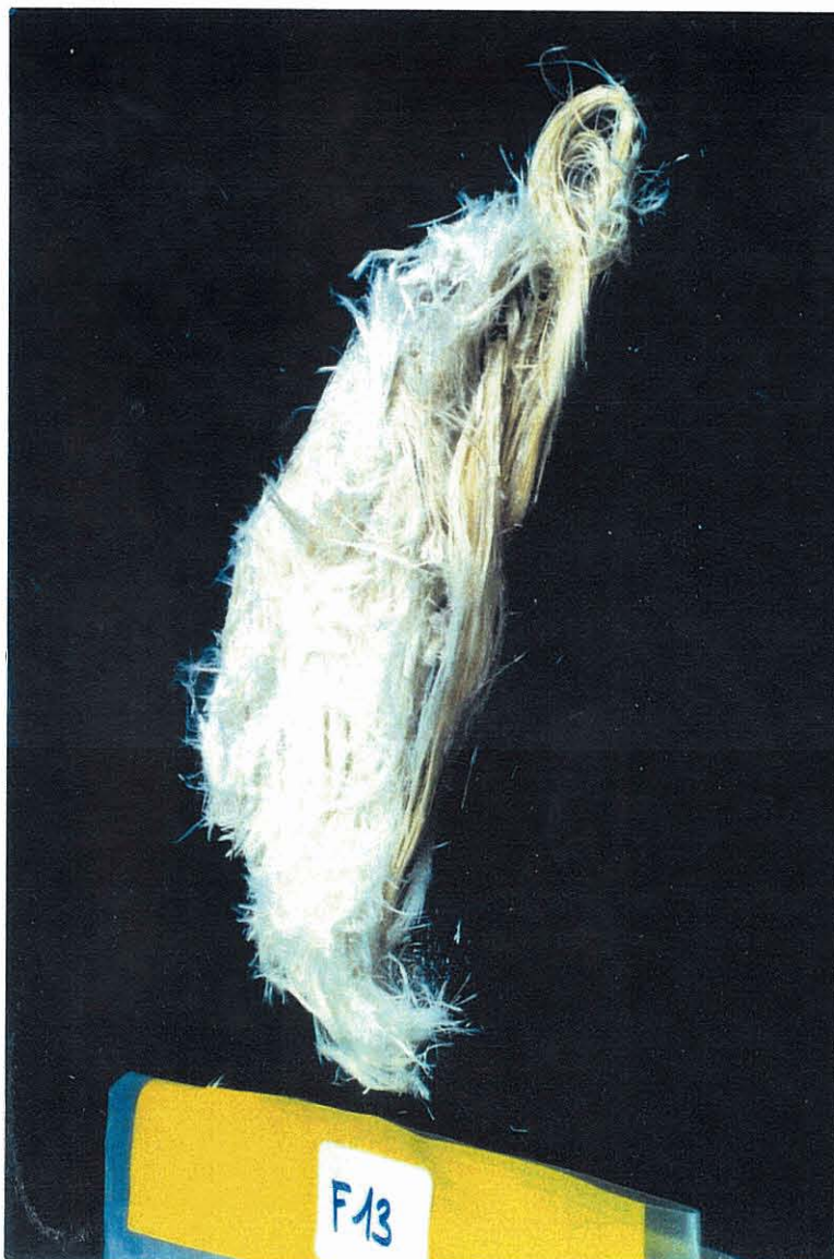
Fig. 7 - Fibres d'amiante (1 o plan) sur fibres organiques.
