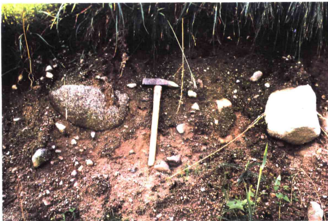
Ph. 10 - Moraine : blocs, galets et fragments de granite flottant dans une masse sablo-limoneuse compacte (bourrelet morainique de Kruth, Haut-Rhin).
