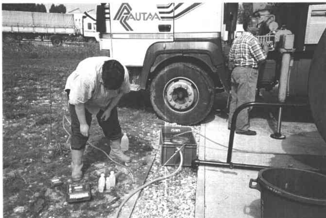
Fig. 1a - Outillage de prélèvement de fluide géothermal en tête du puits de production : prélèvement de gaz libres et de gaz dissous et mesure de GLR (Gas Liquid Ratio).
