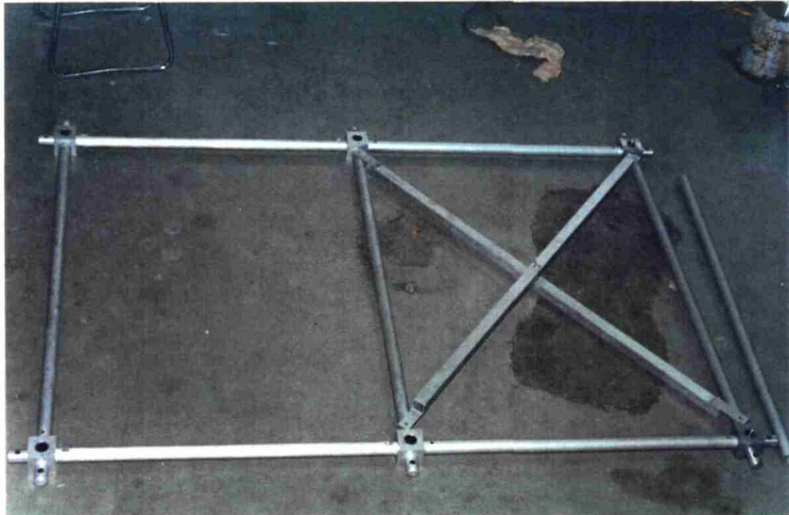
Figure 7 - Gabarit de perçage avec pièces supplémentaires pour extension à une station voisine
